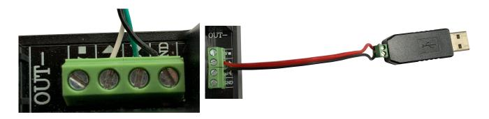
Nachdem die Kabel, wie im Bild und der Tabelle zu sehen, am Netzteil angeschlossen wurden, kann das Gerät nun mit dem PC via USB verbunden werden. Im Geräte-Manager kann unter "Anschlüsse (COM & LPT)" geprüft werden, an welchen Port das Netzteil angeschlossen ist. In diesem Fall ist es COM4.
