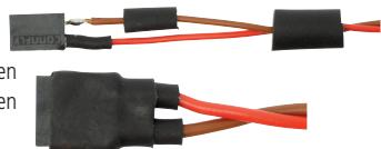
Beispiel für die Konventionierung von Verbindungsleitungen mittels Buchsenleisten und Schrumpfschläuchen
