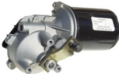
Gleichstromgetriebemotor mit 2 Geschwindigkeiten. Betrieb an 5-12VDC 0,4-1,6A Leerlauf, Drehzahl bei 12V 105/40 Upm, rechts-/ linkslaufend durch Umpolung. Pinbelegung: 31b = Masse, 53 = langsam, 53b = schnell, Wellen-ø 10 mm, Motor-ø 62 mm, Motorlänge 180 mm. Antriebshebel abschraubbar (M8). Einfache Befestigung über 3-Gewindebuchsen M6.
