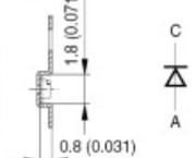
Weißer SMD-LED's superhell, 1x2mm, bleifrei. Hersteller Fa. OSRAM, Type LW L283 Bauform 0603, extrem hell, IF 10mA, VF 3,1V.
