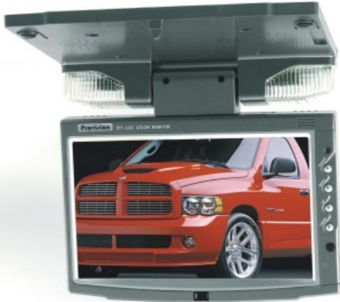
LCD-Farbbildschirm zur Montage im Auto. Geeignet zum Anschluss an jede Videoquelle (Kamera, DVD-Player, Receiver usw.). Der Monitor kann nach der Montage am Fahrzeughimmel einfach heruntergeklappt sowie gedreht und geschwenkt werden.
