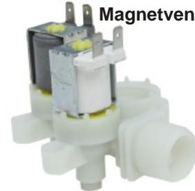
2-Wege Magnetventil zum Einsatz als Ersatzteil in vielen Waschmaschinen unterschiedlicher Hersteller, zum Bau von Bewässerungs-Steuerungen, Dosiereinrichtungen usw. Spulenspannung 230 V~, 100 %ED, 6,3 mm Flachsteckanschlüsse, Eingang 3/4 " Schlauchanschluss, Ausgang 2 Schlauchanschlüsse, Ausgang 2 Schlauchanschlüsse ø 10,5 mm, 4 Befestigungsbohrungen ø 6 mm, Maße 93x85x82 mm
