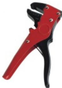
Selbststellend für Kabel von 0,2...6 mm<sup>2</sup>. Keine Beschädigung des Innenleiters. Zusätzlicher Kabelschneider. Gesamtlänge 175 mm. Pos.E9565 nur... € 1,20
