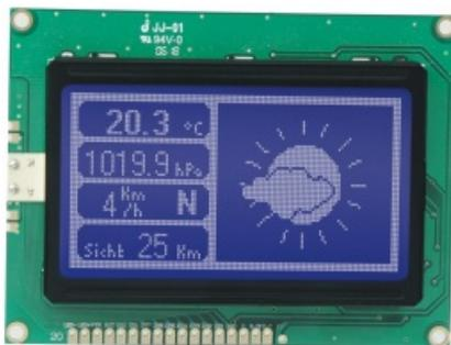
Grafikdisplay TG12864B-03 mit weißer LED-Hintergrundbeleuchtung zur Anzeige von Grafiken, Bildern, Kurven, Spektrum mit einer Auflösung von 128x64 Pixel. Blaues LC-Display, Pixelgröße 0,48x0,48 mm mit integriertem Controller (kompatibel zu KS0108). Betriebsspannung +5 V, Kontrastspannung +9 V, Daten-Input 8-Bit parallel, Anzeigefläche 70,7x38,83 mm, Maße (BxHxT): 93x70x13,6 mm.
