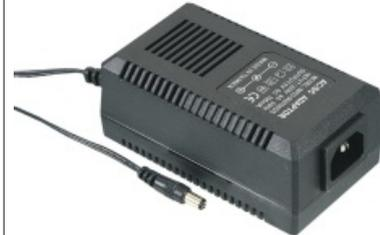
Eingang 230 V~, Ausgang 6 V-/700 mA. Eingangsseitige Kaltgerätebuchse. Ausgangsseitiges Anschlusskabel 1,8 m mit Hohlstecker 5,5/2,1 mm. Pluspol innen. Maße (LxBxH): 118x66x48 mm.
