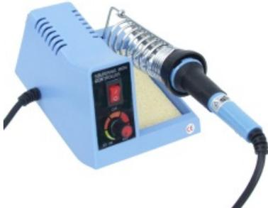
Betrieb an 230V~ 50W, Temperatur regelbar von ca. 150° - 450°C, kurze Aufheizzeit, außenbeheizte Lötspitze, leicht wechselbar, mit Schwammhalter und beleuchtetem Netzweippschalter.
