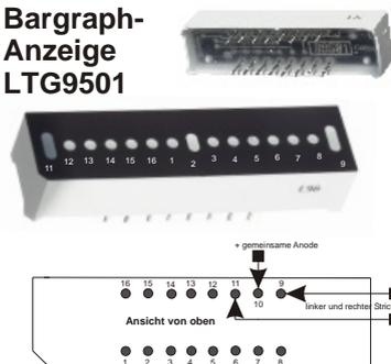
Bargraph-Anzeige, superhell rot, von der Fa. Liteon, Type LTG 9501H. Im Modul sind insgesamt 15 rote LED's. Die beiden End- und Anfangsbalken werden gleichzeitig angesteuert, getrennt von den anderen. Alle anderen LED's sind einzeln herausgeführt (gemeinsame Anode). Ideal für Aussteuerungsanzeigen, Lauflichter, Spannungsmessgeräte, Tendenzanzeigen etc.. Maße (LxBxH) 39x10x8,3 mm
