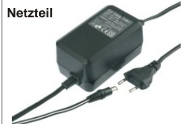
Eingang 230 V~, Ausgang 30 V-/400 mA 12VA. Eingangsseitig Eurokabel mit Netzstecker. Ausgangsseitiges Kabel 1,9 m mit Hohlstecker 6,5/3 mm. Minuspol innen. Maße (LxBxH): 97x56x50 mm.
