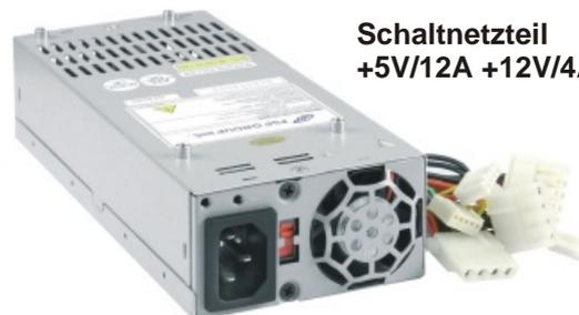
Eingang 115/230 V~. Ausgang +5 V/12 A, +12 V/4 A, +5 Vsb/2 A. Eingebauter 40 mm Axiallüfter. Einschalten des Netzteils durch Verbinden der grünen und schwarzen Leitung. Bauhöhe nur 43 mm (ohne Gewinde). Maße (LxBxH): 195x82x47 mm. Pos. E9215 per Stk. nur..... €7,95
