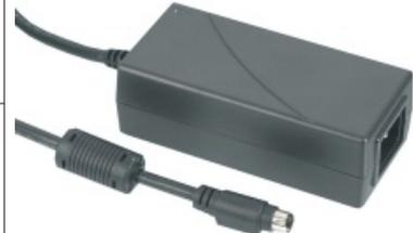
Eingang 100...240 V~ über Kaltgerätestecker, Ausgang 5 V-/1,5 A und 12 V-/1,5 A. Anschlusskabel 1,2 m mit 4-poligem Mini-DIN-Stecker. Maße (LxBxH): 115x54x38 mm.
