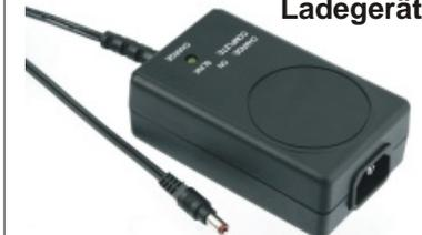
Ladegerät für Akkupacks mit 10 NiMH-Zellen (12 V=). Ladestrom 150 mA. Statusanzeige über LED. Eingang 100...240 V~ über Kaltgerätebuchse, ausgangsseitiges Anschlusskabel 2,7 m mit Hohlstecker 5,5/2,5 mm. Maße (LxBxH): 110x66x41 mm.
