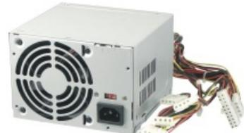
Hochwertiges, leises 200 Watt Schaltnetzteil mit 92 mm Lüfter. Maße (BxHxT): 150x105x140 mm. Achtung: Vor dem Netzanschluss muss die Schaltstellung des Spannungswahlschalters überprüft werden. Auf 230 V stellen!
