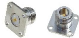
N-Buchsen mit 4-Loch-Flansch ca. 25x25mm. Der vergoldete flache Anschlußpin ist ca. 3mm breit und 3mm hoch. Hersteller Fa. Connquest, England. Pos.E9325 5er Pkg. nur... €5,95
