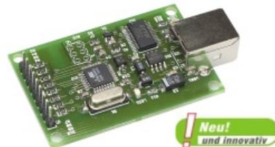
Dieses Datenerfassungssystem wird einfach an die USB Schnittstelle eines PC's angeschlossen. Nach der Installation des mitgelieferten Treiber auf CD wird das Gerät als ein virtueller serieller Port erreichbar. Das System kann bis zu 8 analoge Signale in einem Spannungsbereich von 0..2047mV erfassen. Mit einem auf CD beigefügtem Programm, können Beispielmessungen durchgeführt werden.
