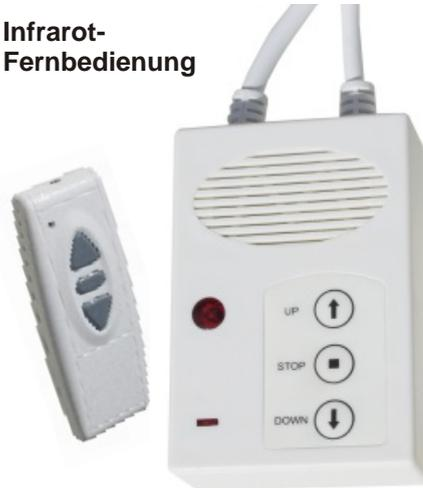
Infrarot-Fernbedienung für Leinwand, weißes Aufputzgehäuse mit Montagehalterung, Auf-Stop-Ab-Funktion, Zuleitungslänge jeweils 3m (1x mit Schukostecker, 1x offen), Kabelquerschnitt 4x0,75qmm, Betriebsspannung 230V/50Hz, Maße LxTxH 105x70x30mm. (Elektronik ist universell einsetzbar z.B. Roll-laden, Markisen usw.). Pos.E9205 ..... € 39,95
