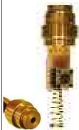
Laserdiode zum Einbau in Anzeigevorrichtungen, Lichtschranken, Messgeräten etc. <5mW OUT 635nm rot Betrieb an max. 4,5V. Durchmesser 12mm, länge ohne Feder 26mm.
