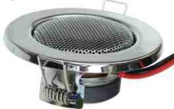
Miniatur Lautsprecher im Halogendesign. Befestigung mittels Spannfeder. Leistung max. 15W an 8 Ohm, Frequenzbereich 120-18000Hz, Lochkreisausschnitt 60mm, Einbautiefe ca. 25mm, Farbe chrom. Pos.E1700 Lautsprecher nur..... 3,90
