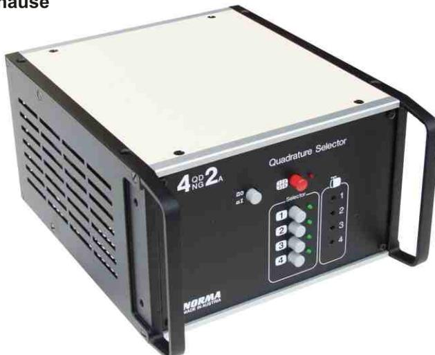
Formschönes Alugehäuse, Deckel und Bodenplatte abschraubbar, eingebautes Netzteil, Trafo 220V/15V/5A mit Gleichrichterplatine, 4 Eurokarteneinschübe, Maße: (HXBXT) 133x218x280mm, das Gerät ist zum Zerlegen gedacht, die ursprüngliche Funktion war ein Quadranten System, man kann 4 Videobilder auf einem Monitor darstellen. Allerdings muß man beachten das man extern synchronisierbare Kameras verwenden muß. Die Geräte sind neu. **Pos.E2075** Alugehäuse nur..... 39,95
