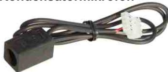
Frequenzbereich 50-14000Hz, Impedanz ca. 1KOhm, Betriebsspannung 1,5-10V, gummi gekapselt, mit 55cm langen Anschlusskabel und Stecker. Mikrofonkapsel-Abmessungen 14x14x22mm. Pos.E1735 Mikrofon per Stk. nur..... -45
