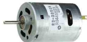
Hochleistungs-Gleichstrommotor mit 5-teiligem Anker, einsetzbar in alle Modellbaubereiche. Hohe Lebensdauer durch großdimensionierte Kohlebürsten. Betrieb an 3-9V/max. 3,5A, ca. 5000-15000Upm. Motordurchmesser 28mm, länge 43mm, Achs-Ø 2,3mm, länge 13mm. Befestigung an der Stirnseite über 2-M2,5 Gewindebuchsen. Pos.E1740 nur..... 1,60
