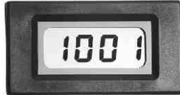
Digitales 31/2stelliges LCD Voltmetermodul, max. Eingangsspannung 199,9mVDC, Eingangswiderstand >100MOhm, Betriebsspannung 9-12VDC und ca. 1mA, Dezimalpunkt setzbar, Anschlußbelegung liegt bei. Außenmaße 68x44x 14mm, Frontplattenausschnitt 54x38mm.
