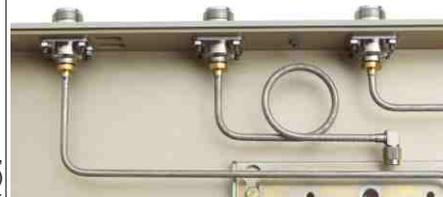
19" Einschub 1HE , 3 x N-Flachbuchsen 50 Ohm mit Semirigid Kabel mit SMA Stecker, der Einschub ist neu. **Pos.E2080** 19" Einschub nur..... 8,90
