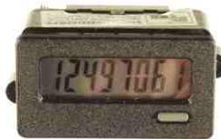
8-stellige, 9mm hohe LCD Anzeige Stromversorgung eingebaut 3V Lithiumbatterie, Lebensdauer ca. 7 Jahre. Der Impulszähler erfaßt Impulse bis 10KHz und zeigt diese an. Gehäuse B51xH28xT40mm, Schalttafel Ausschnitt 45x22mm.
