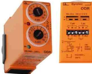
Taktgeber Zeitrelais, Ein-/Ausschaltzeit getrennt einstellbar nach Skala 0-10, mal 0,1 oder 1, schaltbar in sec., min., Std. Betriebsanzeige grüne LED. Schaltzustand rote LED. Betrieb an 220-240V~ oder 24V=~, Schaltausgang über Relais 1-polig UM 10A/250V~2000VA, Anschlüsse 8-poliger Stecksockel. Maße: 48x27mm, höhe 91mm. Pos.E1890 Zeitrelais nur..... 6,90
