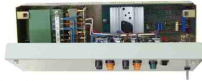
19" Netzteileneinschub, Abbildung mit aufgeklappter Frontplatte. Das Modul ist zum Ausschichten gedacht, großer Netztrafo 220V~/2x27V/5A mit Drosseln, Siebelkgruppe, Regelelektronik etc. Maße: 445x152x114mm. **Pos.E2095** nur..... 24,95
