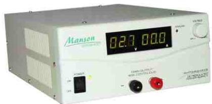
Schaltnetzteil SPS 9400 für sehr hohe Ausgangsströme bis zu 40A. Die Ausgangsspannung läßt sich zwischen 3V und 15V kontinuierlich einstellen, oder über den Schieberegler an der Unterseite, kann auch auf eine Fixspannung von 13,8V geschaltet werden. Digitale Strom- und Spannungsanzeige. Überlast- und Kurzschlußfest (optische Anzeige). Betrieb an 230V~. Maße:(B/H/T) 220x110x300mm, Gewicht 3,5Kg. Ideal als Stromversorgung für die Funktechnik, im Laborbereich und Werkstättenbereich.
