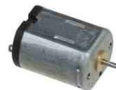
Betriebsspannung 0,3-3V, ideal zum Einsatz im Modellbaubereich, für Kleinstantriebe, Motor-Ø ist 12mm, länge 16mm, Achs-Ø = 1mm, l = 3,5mm Pos.E1750 nur..... 1,30
