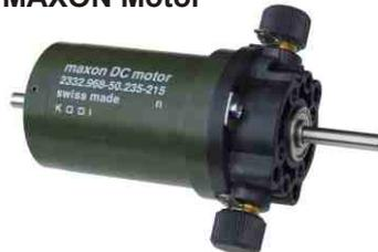
Kugelgelagerter Präzisionsmotor mit wechselbaren Kohlebürsten, beidseitig ausgeführter Achse, Achs-Ø = 4mm, länge 19mm, hinten 10mm. Motorlänge 66mm, Durchmesser ohne Bürsten 38mm(59mm). Betrieb an 1,5-24V/13W max. 745mA, 5480 Upm. Pos.E1755 DC Motor 2332.968 nur..... 9,90
