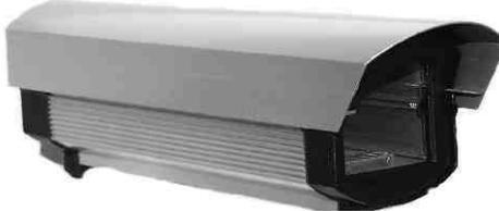
Professionelles Gehäuse für alle kompakten CCD-Kameras in stabiler wetterfester, eloxierter Alu Ausführung. Komplett mit eingebauter Heizung und einstellbarem Sonnendach. Die Heizung verhindert die Bildung von Kondenswasser bzw. das Beschlagen der Scheibe bei niedrigen Temperaturen. Technische Daten: Heizung 12-24V/40W 20C°, Maße 330x103x98mm (LxBxH), Gewicht 1,3kg.
