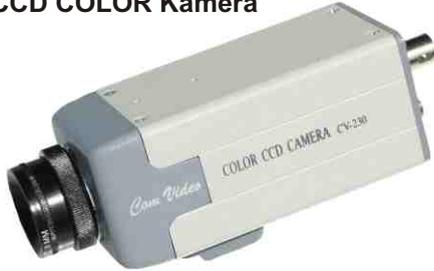
Die hohe Auflösung von 450 TV-Linien und der geringe Lichtbedarf des SONY 1/3" HAD CCD Senors (0,85 Lux) ermöglichen eine große Anwendungsbandbreite. Einfache Montage über Kamera-Stativgewinde, z.B. auf Wandhaltern oder in wetterfesten Außengehäusen möglich. Technische Daten: Betrieb an 12V DC/2,1W, Bildpunkte 537(H)x597(V), Auto Shutter 1/50--1/125,000sec., Videonorm PAL 50Hz, Ausgangspegel 1,0Vpp(75ohm), Maße 105x48x45mm. Lieferung erfolgt ohne Objektiv.
