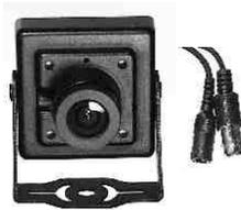
CCD-Kamera S/W im Metallgehäuse einfache Montage mit Befestigungsbügel, Neigungswinkel einstellbar, Spannungsversorgung 12V 1,2W stabilisiert, Videoausgang 1 Vpp/75 Ohm, Zeilenfrequenz 15.625KHz, Bildfrequenz. 50Hz, >400 Zeilen, 250.920 Pixels, 0,3 Lux, Objektiv und Erfassungswinkel 3,6mm F1,4/92,6°, Abmessungen 36x36x28mm, Anschluß über ein 30cm langes Kabel mit DC Kupplung und BNC Buchse für direkten Anschluß an jeden Monitor oder Fernsehgerät mit Videoeingang.
