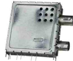
MPM-1000T Modulator mit Video- und Audioeingang, UHF Ausgangssignal einstellbar von Kanal 32 bis Kanal 40. Betriebsspannung 12V, Eingänge: Video 1 Vss, Audio 400mVeff. Maße (BxHxT) 16x55x53mm. Pos.E1675 nur..... 4,95
