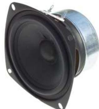
Magnetisch geschirmter Lautsprecher mit Gummisicke geeignet als Surround-Effektlautsprecher. Impedanz 8 Ohm, 20/35 Watt. Abmessungen Korb 127x127mm, tiefe 70mm
