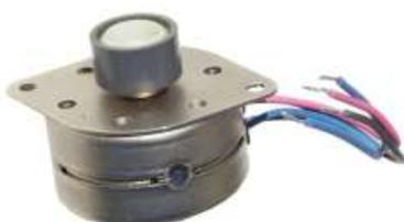
Betrieb an 24VAC, Spule 123 Ohm, 50/60Hz zusätzlich erforderlicher Kondensator 10µF. Abmessungen Motor50x36x33mm, Durchmesser Antriebsrolle 15,8mm.
