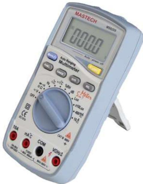
Dieser Multitester bietet besonders interessante Messmöglichkeiten und vereint 5 verschiedene Messgeräte in einem. Neben den gängigen MultimETERfunktionen lassen sich zusätzlich 4 verschiedene physikalische Größen messen: **Temperatur, Beleuchtungsstärke, Schallpegel, Luftfeuchte.**
