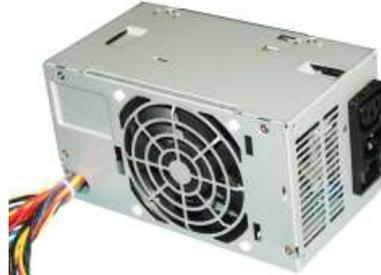
Schaltnetzteil **Model AA21870** S26113-E455-V30 mit einer max. Spitzenausgangsleistung von 145W (10sec.) und einer max. Dauerausgangsleistung von 110W. Netzanschluß 100-127V~; 200-240V~/3A. Ausgangsspannungen: +12V/3,5A max. (6A 10 sec.); +5V/10A max.; +3,3V/8A max.; -12V/0,4A max.; AUX. Ausgang +5V/2A max.. Gehäuse Maße ca.: (HxBxT) 100x180x102mm.
