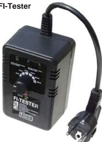
Mit diesem Tester können Sie die Funktionsfähigkeit Ihres FI-Schalters überprüfen. Einfach in die Steckdose stecken, FI-Schalter-Wert einstellen und rote Taste drücken.
