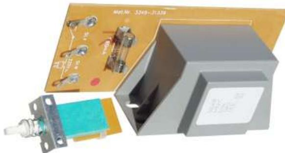
Netzteilmodul mit Netzdruckschalter und Primärsicherung, zur einfachen Befestigung hat der Transformator 4 Bohrungen. Eingang 230V~, Ausgang 9V~ 700mA. Abmessungen:(LxBxH) 120x45x53mm. Pos.E4040 nur € 1,95
