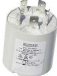
Netzfilter 250V/10A, 0,15uF(X2)+2x0,0047uF(Y) 2x0,5mH+1,5MOhm, 0= 38mm, höhe 50mm
