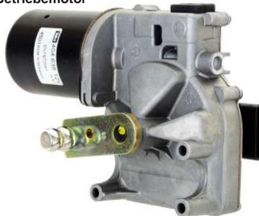
Schneckengetriebemotor mit 2-Geschwindigkeiten 30/46Upm bei Betrieb an 12V=, rechts-linkslaufend. Motor läuft bereits bei 5V an. Motordurchmesser 61mm, länge 195mm, höhe 130mm.
