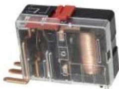
Gepoltes Relais mit Schaltstellungsanzeige und Handbetätigung. Hohe Schaltleistung 25A/250V- 1-polig UM, Spule 18V= (Betrieb an 12-24V möglich). Spule 2x110 Ohm bistabil
