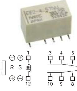
Doppel Spulenrelais bipolare Ausführung mit 4,5VDC Spulenspannung, 145 Ohm je Spule, 2-polig UM 2A/250V~. Maße:(LxBxH) 15x7,5x10mm
