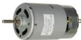
Idealer Motor für Modellbau, Akkuwerkzeuge usw. Anlaufspannung ca. 1V, Betriebsspannung 3-15V, Stromaufnahme im Leerlauf ca. 180mA bei 12V, Drehzahl bei 12V ca. 3000Upm. Maße: Achs-0 3,2mm, Länge 9mm, Motor-0 37mm, Länge 70mm.
