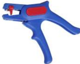
vollisolierte automatische Abisolierzange für alle gängigen flexiblen und massiven Leiter von 0,2 - 6,0qmm, einstellbarer Längenanschlag von 5-12mm, bei Bedarf herausnehmbar, integrierter, gut zugänglicher Seitenschneider bis 2mm. Pos.E2780 per Stk. € 14,90
