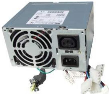
145 Watt Schaltnetzteil mit standard Abmessungen für fast alle Computergehäuse. Mit Netzschalter, Lüfter, Kaltgeräte Einbaustecker und Buchse. Eingangsspannung 115/230V~, Ausgang +5V/18A; +12V/6A; -5V/0,3A; -12V/0,8A. Maße (BxHxT) 150x85x140mm.
