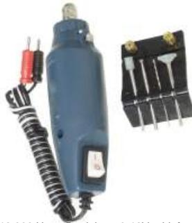
8.000-12.000 Upm. Betrieb an 9-18V=, Lieferung mit Schnellspann-Bohrkopf für Bohrer bis 3mm, Schleifer, Bohrer, Gravierer. Handliches Gerät nur 110mm lang, mit Ein/Aus Schalter. Stromverbrauch bei 12V ca. 300mA. Pos.E2795 per Stk. nur..... €8,50
