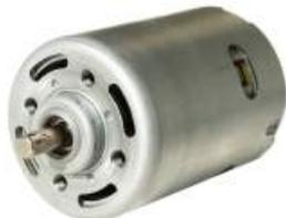
Hochleistungs-Gleichstrommotor mit einem enormen Drehmoment. Ursprünglich eingesetzt in einem Akkuschauber, Betrieb an 12V=(6-16V) max. Strom 90A, Leerlaufdrehzahl 17500 Upm. Maße: Motordurchmesser ist 52mm, länge 135mm, Achsdurchmesser 6,35mm, länge 12,8mm. Zur Befestigung befinden sich an der Stirnseite 4-Gewindebuchsen M5. Ein hochwertiger Motor für den Modellbau z.B. Schiffsbau, RC-Cars, Elektroflug.
