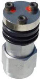
Frequenzbereich DC bis 2500 MHz, VWSR besser 1,1:1 bis 1 GHz, maximal 5W Dauerleistung, Impedanz 50 Ohm, HF-Anschluß N-Norm Stecker.
