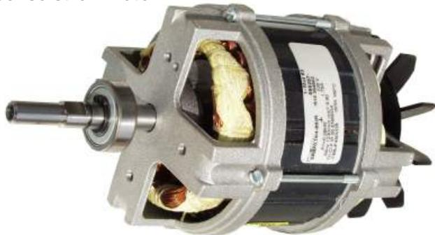
Einphasen Wechselstrommotor mit Betriebskondensator und Schraubklemmleiste, Betrieb an 230V~/50Hz/ 0,36KW/ 1230/Upm, rechts-/linkslaufend, Befestigungsmöglichkeit an der Stirnseite, 4-Gewindebuchsen M5, Motor mit Lüfterrad, Maße Motor ohne Achsen: Durchmesser 114mm, Länge 118mm, Achs-0 12mm, vorne 10mm auf 23mm länge, Gesamtlänge 67mm. Pos.E2690 per Stk. nur..... €12,90
