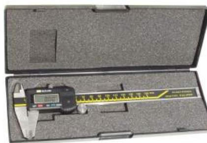
Schiebelehre höchster Güte. Messbereich 150mm. Anzeige in Inch und Millimeter. technische Daten: Ziffernwert Anzeige: 0,01mm/0,05 in Genauigkeit(DIN) Fehlergrenzen: 0,02mm auf 100mm, 0,03 über 150mm. Meßsystem: Kapazitiv, Anzeige LCD, Ziffernhöhe 6,5mm, Stromversorgung: 1 Batterie 1,5V Typ SR44 165mAh. Pos.E2800 Schiebelehre nur..... €39,90
