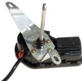
Betrieb an 12V= / 0,8A mit Rückstellkontakt, Achsdurchmesser 6mm, länge 83mm, Maße Motor ohne Befestigungsbügel 116x69x60mm.
