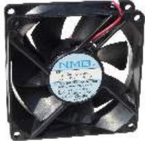
DC-Lüfter 12V/300mA, Typ NMB 3110KL, Maße 80x80x25mm.
