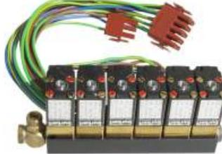
Bürkert Magnetventilblock bestehend aus 6 Magnetventilen Typ 301-C-1,6-B Flansch-R-A15, Spule 220V~/= 4W, PN 0 - 6 bar, direktwirkendes Magnetventil aufgef lanscht, Medium neutrale Gase und Flüssigkeiten die den Gehäusewerkstoff und den Dichtstoff nicht angreifen.
