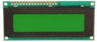
Display Modul mit grüner Hintergrundbeleuchtung, Standard Ausführung 2x16 Zeichen, Inline Anschluß 16-polig, wobei Pin 15+16 die Hintergrundbeleuchtung ist. Betrieb an +5V, TTL und 5V CMOS kompatibel, Schnittstelle für Mikroprozessor-Bus. Außenmaße 80x36mm, Display 61x15,8mm
