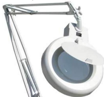
Die ideale Kombination von Lupe und Kaltlicht ermöglicht langes, ermüdungsfreies Arbeiten. Allseitig verstellbar durch Federgelenkarme, dadurch haben Sie immer beide Hände frei. Arbeitsradius ca. 1m. Eine Ringleuchstoffröhre mit 22 Watt sorgt für eine gute Ausleuchtung der Arbeitsfläche ohne Erwärmung. Die 3-Dioptrien Glaslinse (120mm) wird von einer Schutzklappe zuverlässig vor Verschmutzung und Sonne geschützt. Wipp Ein/Aus-schalter. Farbe hellgrau, mit Tischklemme und Anschlusskabel.
