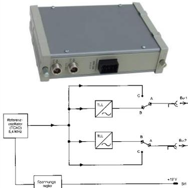
Die Grundschiwingung des Referenzoszillators wird durch einen integrierten, temperaturkompensierten Quarzoszillator 6,4 MHz +/-1ppm erzeugt. Betriebsspannung 12V/32mA. Maße: (BxHxT) 47x180x132mm. Modul für Bastelzwecke, (HF-Gehäuse), kein Schaltplan vorhanden. Die Module sind neu. Pos.E2580 Oszillatormodul nur € 3,90
