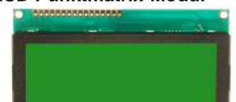
Display Modul mit grüner Hintergrundbeleuchtung, Standard Ausführung 4x20 Zeichen, Inline Anschluß 16-polig, wobei Pin 15+16 die Hintergrundbeleuchtung ist. Betrieb an +5V, TTL und 5V CMOS kompatibel, Schnittstelle für Mikroprozessor-Bus. Außenmaße 98 x 60mm, Display 76,3 x 25mm
