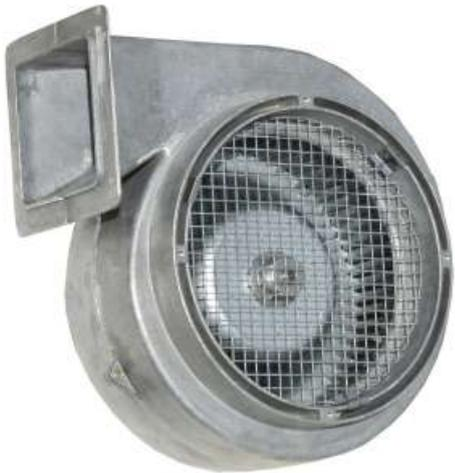
SIEMENS Radialgebläse HI-POT 2300 VAC Thermal Protected, Betrieb an 180-259V in Dreieck Schaltung mit 0,63A oder 333-448V in Y Schaltung mit 0,37A, 50Hz, 1390Upm. ca. 150W. Anschlüsse über ein 2m langes 7-poliges Kabel. Das Gehäuse ist aus Alu Druckguß, sehr stabile Ausführung. Gebläsedurchmesser ca. 290x150mm ohne Luftaustritt, Maße Flansch 140x140mm, Luftaustrittsöffnung 98x100mm. Dieses starke Radialgebläse ist gut für Raumbelüftung geeignet. Pos.E4510 per Stk. nur..... €43,95
