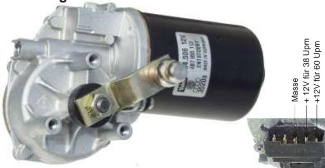
SWF-Schneckengetriebemotor mit zwei Geschwindigkeiten, 60 Upm und 38 Upm, rechts-/linkslaufend, Betrieb an 12V $\pm$ , Motor Valeo 404.506, Motor läuft bereits bei 5V an, Leerlaufstromaufnahme bei 60 Upm 1A und bei 38 Upm 600mA, einfache Befestigung an der Getriebeseite mit 3x M6-Gewindebuchsen, Antriebsbügel abschraubbar. Maße: (LxHxT) 170x98x65mm. Pos.E4521 VALEO 404.506 Getriebemotor per Stk. nur..... €14,90
