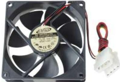
Systemlüfter zum zusätzlichen Einbau, einfach zum Anschliessen. Betrieb an 12V/0,17A, Model AD0912MB-A7, Maße 92x92x25mm
