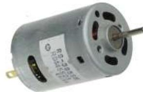
Hochleistungs-Gleichstrommotor mit 5-teiligem Anker, Hohe Lebensdauer, Betriebsspannung 3-9V/ ca. 3,5A, 5000-15000 Upm. Abmessungen Gehäuse-0 28mm, Länge 43mm, Welle-0 2,3mm, Länge 13mm. Zur Befestigung sind an der Stirnseite zwei M2,5 Gewindebuchsen. Pos.E4545 Motor RS385SH nur..... €1,60
