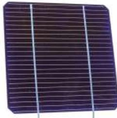
Monokristalline Solarzelle mit einer Größe von 100x100mm, Nennspannung 0,5V, maximaler Stromabgabe von 3A. Zum Bau von Solargeneratoren oder zur Versorgung von Solar-motoren.
