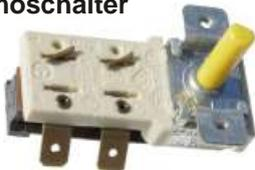
Regelbarer Bimetall-Schalter, Bereich ca. 0°C bis 55°C, für Heizlüfter Raumthermostat etc. Kontakt öffnet bei erreichter Temperatur, einfache Befestigung mit 2x M3 Gewindebuchsen an der Frontseite, Schaltleistung 6A/ 230V $\pm$ , Achse 6mm, l= 15mm Pos.E2635 nur..... €1,95
