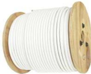
Digitaltaugliches, dämpfungsarmes Koaxialkabel mit Metermarkierung für SAT-TV-Anlagen mit 75dB Schirmungsmaß, Innenleiter 1,1mm, Dämpfung bei 1750MHz 25dB und bei 2250MHz 28dB, Schirmung: doppelte Alufolie und Geflecht, für 7mm F-Stecker, Farbe ws. Pos.M279 100m Rolle nur.... €23,90
