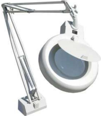
Die ideale Kombination von Lupe und Kaltlicht ermöglicht langes, ermüdungsfreies Arbeiten. Allseitig verstellbar durch Federgelenkarme, dadurch haben Sie immer beide Hände frei. Arbeitsradius ca. 1m. Eine Ringleuchtstoffröhre mit 22 Watt sorgt für eine gute Ausleuchtung der Arbeitsfläche ohne Erwärmung. Die 3-Dioptrien Glaslinse (120mm) wird von einer Schutzklappe zuverlässig vor Verschmutzung und Sonne geschützt. Wipp Ein/Ausschalter. Farbe hellgrau, mit Tischklemme und Anschlusskabel.
