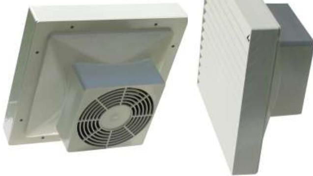
Filterlüfter von McLEAN MIDWEST mit Papst Lüfter Typ 4650N, Schutzgitter und wechselbaren Filter für die schnelle und einfache Zwangsbelüftung von Räumen, Schränken usw., einfacher Einbau. Netzanschluss an 230V~/50Hz, 19W, 2650 min-1, Gleitlager ca.160 m³/h frei ausblasend. Lieferung mit Montageanleitung und Schablone für Ausschnitt und Bohrungen. Abmessungen: 240 x 240 mm, Tiefe 115mm, Einbautiefe 80mm, erforderliche Ausschnitt 120x120mm. Pos.E4515 McLEAN Filterlüfter per Stk. nur..... € 19,95
