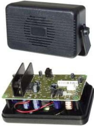
Der Aktivlautsprecher für Freisprech-einrichtungen, bei Telefon, Funk-, Monitorlautsprecher. Einfache Montage mit Bügel. Betriebsspannung 12V~, Ausgangsleistung 3 Watt, Abmessungen (BxHxT): 140x75x64 mm. Lieferung mit Anschlussplan.
