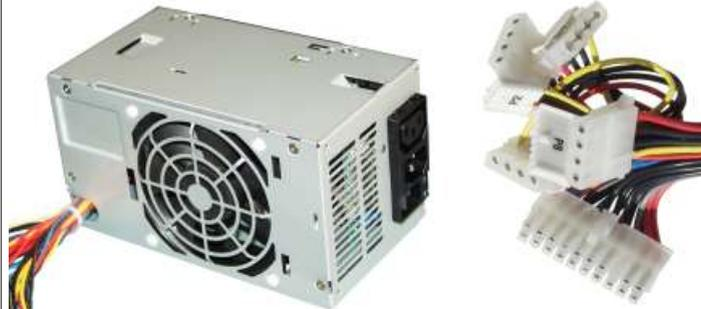
Schaltnetzteil Model AA21870 S26113-E455-V30 mit einer max. Spitzenausgangsleistung von 145W (10sec.) und einer max. Dauerausgangsleistung von 110W. Netzanschluß 100-127V~; 200-240V~/3A. Ausgangsspannungen: +12V/3,5A max. (6A 10 sec.); +5V/10A max.; +3,3V/8A max.; -12V/0,4A max.;AUX. Ausgang +5V/2A max.. Gehäuse -Maße ca. : (HxBxT) 100x180x102mm. Pos.E2900 ATX-Schaltnetzteil nur.....€ 4,95
