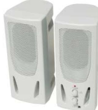
Abgeschirmte Lautsprecherboxen mit eingebautem Verstärker externen Netzteil, geeignet zum Anschluss an Soundkarten, CD-ROM Laufwerken, Walkman, Keyboard usw. Ein-/Ausschalter und Lautstärkereger befinden sich an der Vorderseite einer Box. Betriebsspannung 230V~, Ausgangsleistung max. 120W PMPO, Eingangsempfindlichkeit 300mV. Maße (BxHxT) 95x180x75mm.
