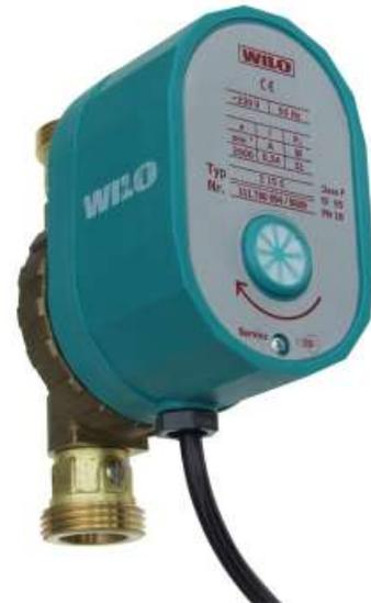
Die Umwälzpumpe Z15 wird zur Förderung von Flüssigkeiten im Trink-/Brauchwasserbereich eingesetzt. Betriebsspannung 230V~ 31W, Einbaulänge 140mm, max. Druck 10 bar, Temperaturbereich des Fördermediums 20 bis 65 Grad. Pumpe mit Rückschlagventil, Anschlusskabel 1,8m mit Schuko Stecker und einer Schaltuhr mit 24h Programm, Einbau- und Betriebsanleitung.
