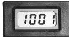
Digitales 31/2stelliges LCD Voltmetermodul, max. Eingangsspannung 199,9mV DC, Eingangswiderstand >100MΩ, Betriebsspannung 9-12VDC und ca. 1mA, Dezimalpunkt setzbar, Anschlußbelegung liegt bei.
