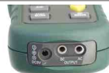
Anschlüsse für ein Netzteil und Signalausgang DC & AC
