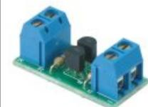
Zum Betreiben von Standard-LEDs an einer Betriebsspannung von 5...24 V-. Durch den konstanten Strom von 20 mA ist eine gleichbleibende Helligkeit und eine maximale Lebensdauer gewährleistet. Desweiteren können mehrere LEDs in Reihe geschaltet werden. Technische Daten: Betrieb an 5..24 V-, Stromaufnahme 20 mA. Maße: 30x14 mm. Pos.N4305 Bausatz nur... € 1,-
