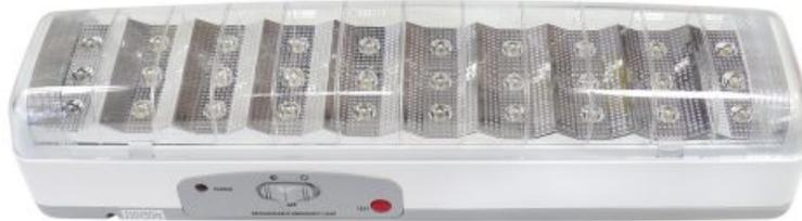
Notleuchte mit 30 superhellen LED's und Akku, universell einsetzbare Lampe für Heim-/Büro/Garten usw. welche bei Stromausfall DC oder AC Betrieb (Akku 6V/4AH) automatisch einschaltet und bis zu 20 Std im Batteriebetrieb leuchtet, Features: 30 superhelle LED's, 6V/2,5AH Akku (wartungsfrei), Batterieanzeige (Low/High), Ladeanzeige, Lampenwahlschalter (DC/OFF/AC), Testfunktion, Maße LxTxH 360x75x85mm. Pos.N3610 Notleuchte nur..... €15,95
