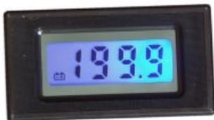
Digitales 3 1/2 stelliges LCD Voltmetermodul, 13mm Ziffernhöhe, schaltbare blaue Hintergrundbeleuchtung max. Eingangsspannung +/- 199,9m VDC, Eingangswiderstand >100MΩ, Betriebsspannung 8-12VDC und ca. 1mA ohne Beleuchtung, Dezimalpunkt setzbar, Anschlußbelegung und eine Tabelle für Spannungs-/ Stromerweiterung liegt bei. Außenmaße (LxBxT) 79x43x17mm, Frontplattenausschnitt 70x39mm. Pos.N0675 nur..... €5,95
