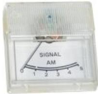
Innenwiderstand 650 Ohm, erforderlicher Frontplattenausschnitt 21,3x36,3mm, Maße Messwerk (BxHxT) 40x41x23mm. Pos.N4530 nur..... €1,95
