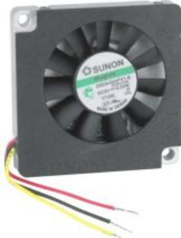
Hochwertiger Radiallüfter zum gezielten Belüften von Baugruppen, Chipsätzen usw. Kabelbelegung: rot = + schwarz = -, gelb = Tacho. Betrieb an 5 V- (3...6 V-) 0,35 W 2,2 CFM, 5500 U/min, 29 dB(A) Maße: 45x45x9 mm. Pos.N4225 per Stk. nur... €1,95
