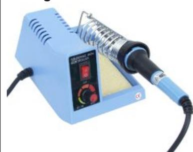
Betrieb an 230V~ 50W, Temperatur regelbar von ca. 150° - 450°C, kurze Aufheizzeit, außenbeheizte Lötspitze, leicht wechselbar, mit Schwammhalter und beleuchtetem Netzwißschalter.
