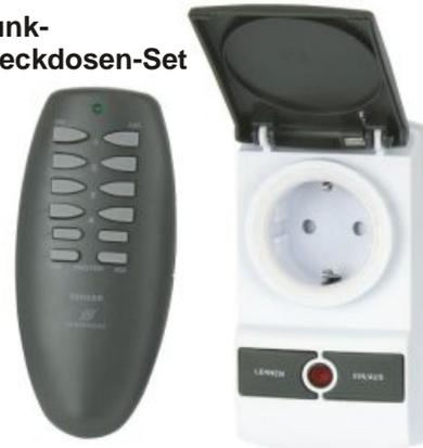
Mit diesem Set können Sie auch im Außenbereich einfach per Funk Geräte ein- und ausschalten - und das auf einer Reichweite von bis zu 40 Metern. Ideal zum Schalten von Beleuchtung, Pumpen etc. für Terrasse, Balkon und Garten. Im Set enthalten sind 2 schaltbare Funk-Steckdosen sowie ein 434 MHz-Handsender für max. 4 Geräte.
