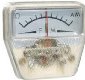
Einbauminstrument +/- 50µA, Innenwiderstand 1500 Ohm, echte Rarität. erforderlicher Frontplattenausschnitt 14x34mm. Maße Messwerk (HxBxT) 36x39x20mm. Pos.N4395 Einbauminstrument nur.... €4,95
