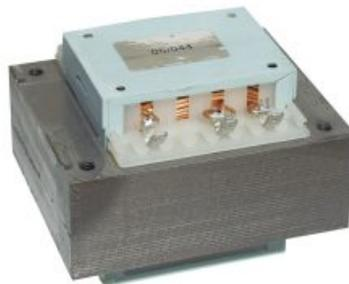
Kräftiger Netztrafo mit 84VA Leistung, Kern EI 84/32 Primär: 230 V / 50-60 Hz, Sekundär: 0-12- 24 V / max. 3,5 A oder auch als 12-0-12 V einsetzbar. Anschlüsse sind Steckfahnen passend für Kabelschuhe mit 4,8 mm. Die Ausführung ist Vakuum getränkt. Abmessungen: (BxTxH) 85x71x65 mm Pos.N3660 per Stk. nur..... €7,95
