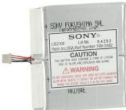
Dieses Akkupack eignet sich als Ersatzakku für PDAs, z.B. i705, Tungsten C, Tungsten W, für Modellbauzwecke usw. Der Pack besteht aus 2 Lithium-Polymerzellen mit je 3,7 V/650 mAh, Zellengröße je 62x35x3,8 mm.
