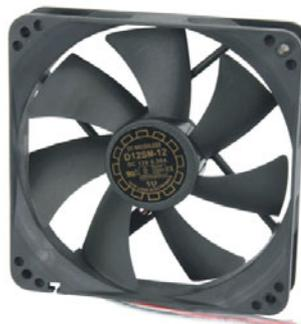
Laufruhiger Axiallüfter mit niedriger Anlaufspannung und dem daraus resultierenden, fast lautlosen Betrieb. Ideal zum Einsatz in Computersystemen. Technische Daten: - Betriebsspannung 12 V- / 300 mA, - Drehzahl 1650 U/min, Volumenstrom 70,5 CFM, Geräuschpegel 33 dB(A), Kabellänge 100 mm, Maße: 120x120x25 mm. N8200 € 2,95
