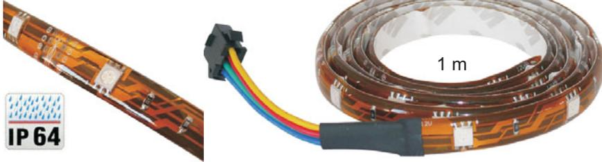
selbstklebend mit 30 RGB-LEDs (Typ 5050) und spritzwasserfest nach IP64. Ideal für direkte oder indirekte Beleuchtung. Es kann alle 3 LEDs abgeschnitten und einzeln betrieben werden. Betrieb mit 12V DC 600mA (200mA je Farbe). Länge 1m. Strip ca. 10x2.1mm. Einfach zum Reinigen. (passend zu RGB-Controller).
