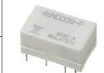
Spule: 9V-/540 Ohm 2-polig UM 1A/30V~ Maße(LxBxH)15,9x 9,8 x 7,9 mm N4775 nur... € -,60
