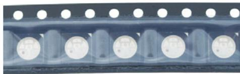
Dreifarben SMD-LED im PLCC Gehäuse, 6 Pin Anschluss, jede Farbe (Anode-/Kathode) einzeln steuerbar. Farbe rot 2.0V / 630nm / 1000mcd, grün 3,2V / 528nm / 2200mcd und blau 3,2V / 435nm / 800mcd, Strom ca. 20mA pro Farbe. Öffnungswinkel 120°. Abmessungen 5x5x1,5 mm.
