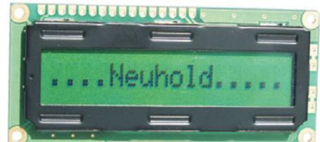
1x16 Zeichen, Typ PowerTip PC1601ARU einfache 5V- Stromversorgung, integrierter Standard-Controller. Maße: 80x36 mm. Datenblatt dazu finden Sie im Onlineshop. Pos.N3550 LCD-Modul PC1601 € 1,40
