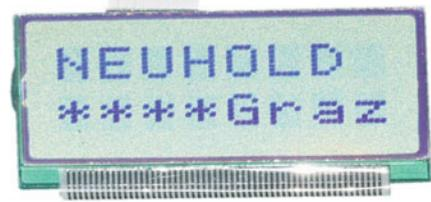
2-zeiliges LC-Display mit 8 Zeichen pro Zeile und Industriestandard-kompatiblen Controller (HD47780 kompatibel). Der Anschluss erfolgt wahlweise über das 10-polige Flachband-Kabel oder über Löt-punkte. **Technische Daten:** Betriebs-spannung 5V-, Anzeigefläche 44x23 mm Zeichengröße 5x3 mm, Ansteuerung über 4-Bit-Datenbus. Maße (BxHxT): 45x26x5 mm Pos.N4105 nur..... € -,95
