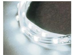
Wasserdichter (IP65), flexibler LED-Strip, Länge 1 m, 66 SMD-LEDs . Der Strip kann jeweils alle 3 LEDs abgeschnitten und einzeln betrieben werden. Betrieb mit 12 V DC/450 mA (66 LEDs), Länge 1 m, selbstklebend. Mit ca. 10 cm langen Anschlusslitzen. Maße Strip ca. 8,5 x 3 mm.
