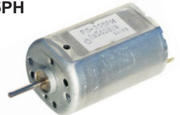
Leistungsstarker Gleichstrommotor mit Gleitlagern aus Sinterbronze. Betrieb an 12-24V=, Leerlaufstromaufnahme bei 24V/145mA, 14800Upm, Strom max. 9,8A. Motormaße: (LxØ) 50x29mm Welle: (LxØ) = 2,3mm, Länge 14mm. N0070 per nur..... € 1,95
