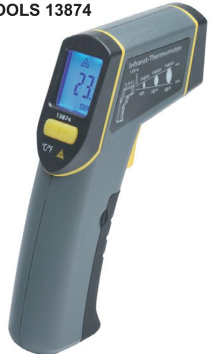
IR-Thermometer zur berührungslosen und damit gefahrlosen Temperaturmessung auch von heißen, beweglichen oder spannungsführenden Teilen. Ideal zum Einsatz bei Service, Wartung und Reparatur von elektrischen Maschinen, Verbrennungsmotoren usw. Messbereich -20...+320 °C Emissionsgrad 0,95 (fest), optische Auflösung 8:1, blaue Displaybeleuchtung. Ziellaser abschaltbar. Betrieb mit 9 V-Block (im Lieferumfang). Pos.N8180 nur.... € 19,95
