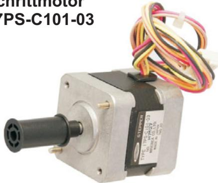
Unipolarer, kugelgelagerter Steppermotor Mineba mit hohem Drehmoment und kompakten Maßen. Technische Daten: Schrittwinkel 3,6° (100 Schritte), Betriebsspannung 12 V, Strangwiderstand 49 Ohm Strangstrom 240 mA, Achse (øxL): 5x25 mm ohne Kunststoffrolle (kann mit Abzieher abgezogen werden), Motormaße ohne Welle (LxBxH): 42x42x41 mm. Pos.N8277 Schrittmotor nur..... € 5,95
