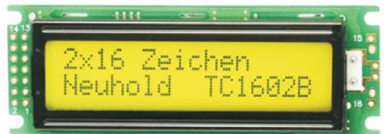
LCD-Displaymodul 2-zeilig mit integriertem Controller und gelber LED-Hintergrundbeleuchtung. Es können pro Zeile 16 Zeichen Text dargestellt werden. Integrierter Controller (Industriestandard HD47780), Betriebsspannung +5 V-, Zeichengröße 5,5x2,96 mm, Anzeigefläche 56x11,5 mm, Maße (BxHxT): 85x30x13 mm. Pos. N8390 € 4,95
