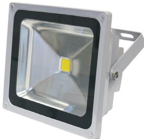
Leistungstarker LED-Flutlichtstrahler mit eingebautem Schaltnetzteil, Alugehäuse. Bestückt mit einer 50 Watt LED, Farbtemperatur: 5500k, 3500Lm, Abstrahlwinkel: 120°, Schutzart: IP65, Farbe: Grau, Betriebsspannung 230V/AC, Maße: 320 x 270 x 180 mm.
