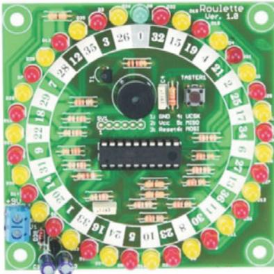
Bei dieser elektronische Rouletteplatine wird durch drücken eines Tasters die Kugel zum Rollen oder in diesem Fall die LEDs abwechselnd zum Leuchten gebracht. Idealer Spaß für Partys, mit der Familie oder mit Freunden. Betriebsspannung 9...12 V- (über 9 V-Block), Stromaufnahme max. 90 mA, microprozessorgesteuert, 37 LEDs, 1 Starttaster, Summer für Kugelgeräusche, Roulette-Zahlen auf Platine aufgedruckt. Abmessungen (LxBxH): 88x88x15 mm. Pos.N8235 € 9,95
