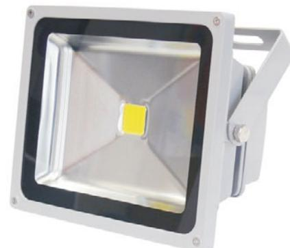
Leistungstarker LED-Flutlichtstrahler mit eingebautem Schaltnetzteil, Alugehäuse. Bestückt mit einer 30 Watt LED, Farbtemperatur: 5500k, 2100Lm, Abstrahlwinkel: 120°, Schutzart: IP65, Farbe: Grau, Betriebsspannung 230V / AC, Maße: 270 x 235 x 165 mm.
