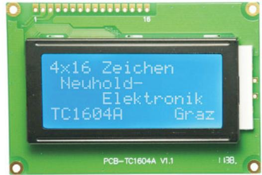
4-zeiliges STN-Displaymodul mit 16 Zeichen pro Zeile Text. Industriestandard-kompatibler Controller (HD47780). Blaues Display mit weißer Hintergrundbeleuchtung, 16-poliger Lötanschluss. Betriebsspannung +5V-, Zeichengröße 4,75x2,95 mm, Anzeigefläche 56,2x20,8 mm, Maße (BxHxT): 87x60x13,5 mm. Pos. N8400 LCD-Display nur... € 7,95
