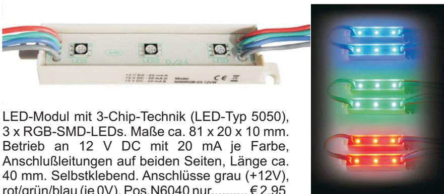
LED-Modul mit 3-Chip-Technik (LED-Typ 5050), 3 x RGB-SMD-LEDs. Maße ca. 81 x 20 x 10 mm. Betrieb an 12 V DC mit 20 mA je Farbe, Anschlußleitungen auf beiden Seiten, Länge ca. 40 mm. Selbstklebend. Anschlüsse grau (+12V), rot/grün/blau (je 0V). Pos.N6040 nur..... € 2,95
