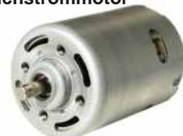
Hochleistungs-Gleichstrommotor mit einem enormen Drehmoment. Ursprünglich eingesetzt in einem Akkuschauber, Betrieb an 12V=(6-16V) max. Strom 90A, Leerlaufdrehzahl 17500 Upm. Maße: Motordurchmesser ist 52mm, länge 135mm, Achsdurchmesser 6,35mm, länge 12,8mm. Zur Befestigung befinden sich an der Stirnseite 4-Gewindebuchsen M5. Ein hochwertiger Motor für den Modellbau z.B. Schiffsbau, RC-Cars, Elektroflug.
