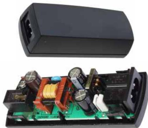
Netz Eingang: 100-240V~, Ausgang: 7,6V-/600mA, Netzanschluss über eine Doppelnutbuchse, Ausgang über eine Modularbuchse, die Anschlussbelegung ist aufgedruckt. Abmessungen: (LxBxH) 97x37x30mm
