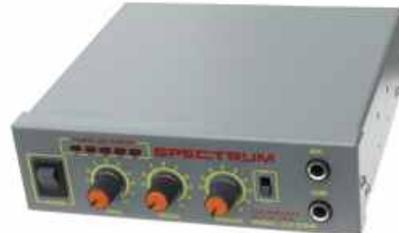
Hochwertiger Mono-Verstärker für das Auto im Metallgehäuse. Umschaltbare Mikrofon- und LINE-Eingänge an der Frontseite, 1 Lautsprecherausgang 4-16 Ohm, getrennte Bass-, Höhen- und Lautstärkeregelung, Ein/Aus-Schalter, Power-LED-Display, Montagebügel. Technische Daten: Betrieb an 10-14V/DC, Ausgangsleistung an 4 Ohm Sinus 9W / Musik 30W, Frequenzbereich 20 Hz - 20KHz, Maße (BxTxH) 175x180x50mm
