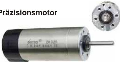
Gleichstrom Präzisionsmotor Type Escap 28D2R zweifach kugelgelagert, Betrieb an 12V=, Leerlaufdrehzahl 5700Upm, Startmoment 96mNm, max. Dauerstrom 1,5A/15W, Anschlußwiderstand 2,5 Ohm, Drehmomentkonstante 20mN/A. An der Rückseite ist ein Impulsgeber angebaut, 144 Impulse per Umdrehung(2 Impulse um 90° versetzt) zusätzliche Spannungsversorgung 5V=. Maße: Motordurchmesser 28mm, länge 75mm, Achsdurchmesser 4mm, länge 20mm. Der Motor besitzt an der Stirnseite zur Befestigung 6 Innengewinde M3.
