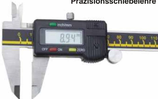
Schiebelehre höchster Güte. Messbereich 150mm. Anzeige in Inch und Millimeter. technische Daten: Zifferwert Anzeige: 0,01mm/0.005 in Genauigkeit(DIN) Fehlergrenzen: 0,02mm auf 100mm, 0,03 über 150mm. Meßsystem: Kapazitiv, Anzeige LCD, Ziffernhöhe 6,5mm, Stromversorgung: 1 Batterie 1,5V Typ SR44 AG-13 165mAh.
