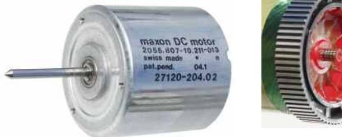
Präzisionsmotor aus einstiger Videorecorder-Fertigung, 2-fach kugelgelagerter eisenloser Rotor, 13-teiliger Silberkolektor mit Edelstahlbürsten, Stator Ferrit-Magnet. Länge der Achse 35 mm mit 4 mm Durchmesser. Zur Befestigung sind an der Frontseite 3-Gewindebuchsen M3, Motordurchmesser 55 mm, länge 52 mm. Nennbetriebsspannung 24V=. Dieser edle Motor läuft bei <2,5V gut an kann ab 6V für Bastelzwecke eingesetzt werden. Leerlaufdrehzahl bei 24V 2830 min-1.
