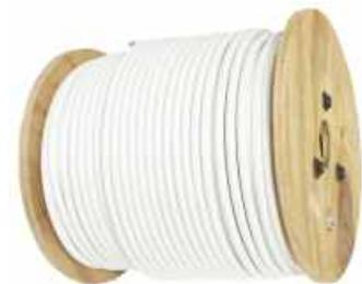
Digitaltaugliches, dämpfungsarmes Koaxialkabel mit Metermarkierung für SAT-TV-Anlagen mit 75dB Schirmungsmaß, Innenleiter 1,1mm, Dämpfung bei 1750MHz 25dB und bei 2250MHz 28dB, Schirmung: doppelte Alufolie und Geflecht, für 7mm F-Stecker, Farbe ws. Pos.M279 100m Rolle nur.... €23,90
