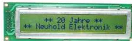
Zweizeiliges LC-Display mit hohem Kontrast in einem formschönen Gehäuse, leicht zerlegbar. Es können 2 x 24 Zeichen dargestellt werden. Display Type L2432 von Seiko, 14-Pin Anschluss über ein 130mm langes Flachbandkabel, Betriebsspannung +5V, Der Kontrast ist über einen externen Einstellregler regelbar. Ansteuerung über 4-Bit oder 8-Bit Datenbus, zwei integrierte Controller (HD44780-kompatibel), getestet mit AT89S8252. Abmessungen 37x118,5x13mm, Gehäuse 130x64x21mm.
