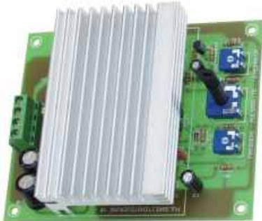
Stufenlose Drehzahlregelung von Niederspannungs-Elektromotoren. Diese Motoren finden hauptsächlich Verwendung in Gleichstrom-Bohrmaschinen, Modellautos, Scheibenwischer-Antrieben, sowie bei Elektrowerkzeugen. Aufgrund der Puls-Breitensteuerung, die mit einer einstellbaren Frequenz zwischen 600 Hz und ca. 2 kHz arbeitet, bleibt die Verlustleistung selbst bei niedrigen Drehzahlen gering. Den Ausgangsstrom von 0 bis 10 A können Sie stufenlos mit einem Trimm-Poti einstellen.
