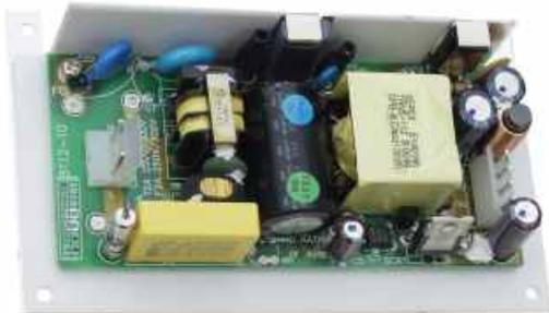
Eingang 100-240V~, Ausgang 12V-/3,5A. Pinbelegung aufgedruckt. Maße(LxBxH): 125x75x26mm. Pos.E5775 nur... € 5,95
