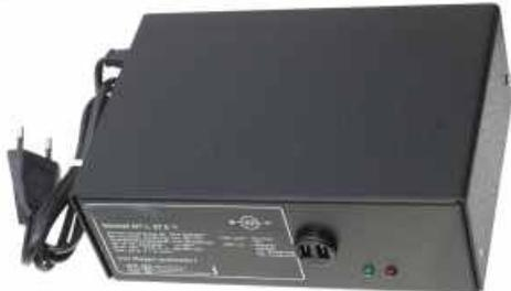
Schaltnetzteil zur Stromversorgung für 24V-Geräte bis zu einer Leistung von ca. 80W mit Lademöglichkeit für 24V Batterien. Elektronisch geschützt gegen Überlast und Kurzschluß. Technische Daten: Eingang 110..240V/50Hz, Ausgang 27,6V(Leerlauf) Dauerlast 3A. Metallgehäuse, Maße(LxBxH): 190x130x75 mm.
