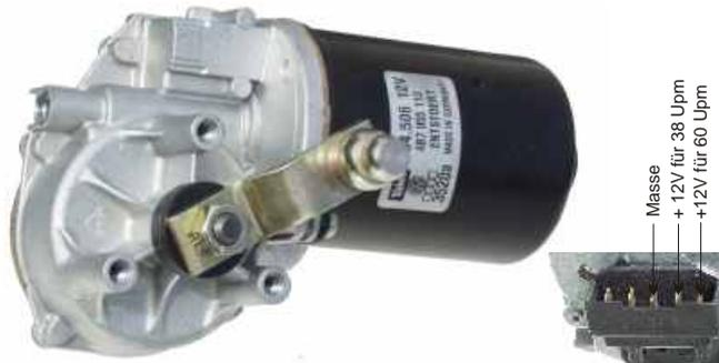
SWF-Schneckengetriebemotor mit zwei Geschwindigkeiten, 60 Upm und 38 Upm, rechts-/linkslaufend, Betrieb an 12V=, Motor Valeo 404.xxx, Motor läuft bereits bei 5V an, Leerlaufstromaufnahme bei 60 Upm 1A und bei 38 Upm 600mA, einfache Befestigung an der Getriebeseite mit 3x M6-Gewindebuchsen, Antriebsbügel abschraubbar. Maße: (LxHxT) 170x98x65mm.
