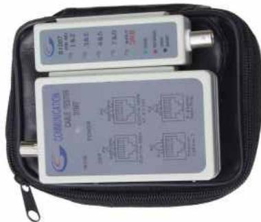
Universal Tester für Netzwerk- und ISDN-Kabelverbindungen. Anschlüsse für RJ45 und BNC. Getestet wird Durchgang, Belegung und Paarigkeit. Durch Sender und Empfänger können auch bereits verlegte Kabel getestet werden. Pos.E5810 Netzkabeltester nur..... €14,95
