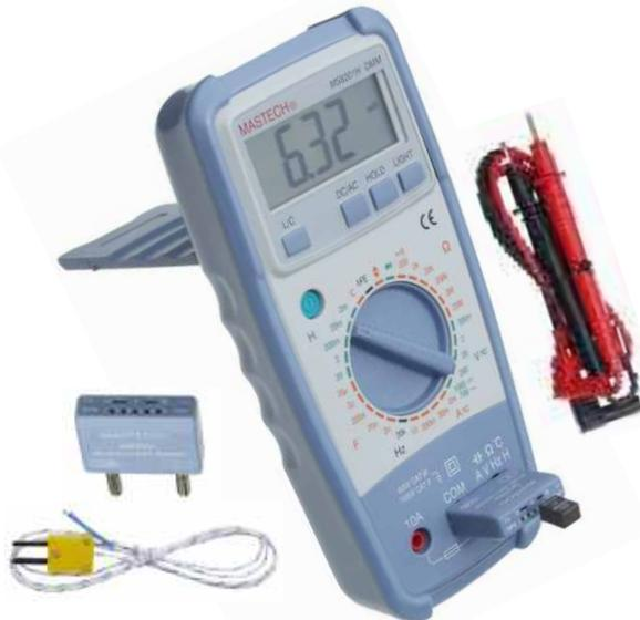
nach IEC-1010 CAT-II, graues Gehäuse mit grauem Gummischutzrahmen und Aufstellbügel, beleuchtetes LCD-Display mit 20 mm hohen Ziffern, Kapazitäts-, Frequenz-, Temperatur-, Induktivitätsmessung, Diodentest und Transistortest, Data-Hold, akustischer Durchgangssummer.
