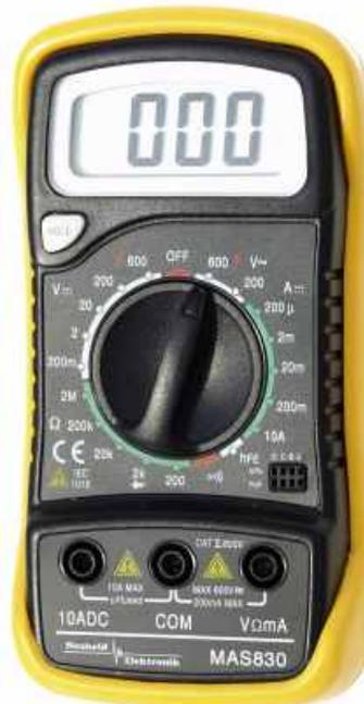
Das MAS 830 ist ein tragbares 31/2-stelliges Digital-Vielfachmeßgerät mit Batteriebetrieb, das für die Messung von Gleich- und Wechselspannungen, Gleichströmen, Widerständen, Dioden und Transistoren sowie für Durchgangsprüfungen (Summer) entwickelt wurde. Spannungsversorgung: 9V-Block-batterie.
