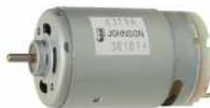
Hochleistungsmotor Johnson Type 63706, Betrieb an 1,5-4,5V-, Stromaufnahme max. 11A, Leerlaufdrehzahl ca. 14000 Upm.
