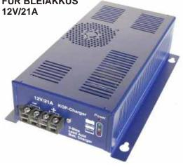
Automatisches Ladegerät mit hohem Wirkungsgrad (Schaltnetzteiltechnik) für Bleiakkus. Die Hauptmerkmale sind getaktetes Ladegerät, automatischer Betrieb mit optimierten Ladevorgang, hoher Wirkungsgrad, kompaktes Tischgerät mit 230V Netzanschluß, Kurzschluß und verpolungsgeschützt, Betrieb und Diagnostikanzeige mit 3 LED's. Netzschalter auf der Rückseite. Lieferung mit Batterieladekabel.
