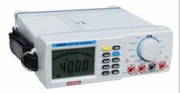
Hochwertiges Labormultimeter für Batterie und Netzbetrieb mit vielen praxisnahen Messfunktionen, manuell/automatische Bereichswahl. Die Messwertdarstellung erfolgt auf einem großen kontrastreichen 3 3/4 -stelligen Multifunktions-Display (68 x 47 mm) mit 18 mm Ziffernhöhe, 42-teiligen Bargraph und zuschaltbarer Hintergrundbeleuchtung.
