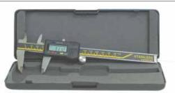
Digitale Präzisionsschiebelehre höchster Güte. Messbereich 150mm. Anzeige in Inch und Millimeter. Technische Daten: Ziffernwert Anzeige: 0,01mm/..0005in, Genauigkeit (DIN) Fehlergrenzen: 0,02mm auf 100mm... Meßsystem: Kapazitiv. Änzeige: LCD. Ziffernhöhe: 6,5mm. Stromversorgung: 1 Batterie 1,5V, SR44 AG13. Pos.E.2800 per Stk. nur.......€19,95
