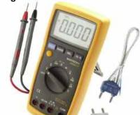
3/4-stelliges Digital-Multimeter MS-8217 mit automatischer-/manueller Bereichsumschaltung, Drehschalter zur Messbereichswahl von Gleich/ Wechselspannung, Gleich/Wechselstrom, Widerstand, Diodentest, Durchgangssummer, Temperatur, Frequenz, Kapazität. Data Hold, LCD Display 3 3/4- stellig mit 20 mm Ziffernhöhe. Gehäusefarbe schwarz mit gelbem Holster und Aufstellbügel.
