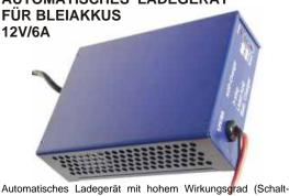
netzteiltechnik) für Bleiakkus. Die Hauptmerkmale sind getaktetes Ladegerät, automatischer Betrieb mit optimierten Ladevorgang, hoher Wirkungsgrad, kompaktes Tischgerät mit 230V Netzanschluß, Kurzschluß und verpolungsgeschützt, Betrieb und Diagnostikanzeige mit 3 LED's. Netzschalter auf der Rückseite. Lieferung mit Batterieladekabel. Maße: (LxBxH) 160x118x48 mm. Pos.E6375 Bleigel-Lader 12V/6A ..... €39,95
