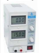
Spannung von 0...15 V- und Strom von 0...2 A regelbar. Mit digitaler, beleuchteter Anzeige für Strom und Spannung, beleuchtetem Netzschalter und 1,6 m Netzkabel. Abmesungen: (BxHxT):95x155x220 mm.
