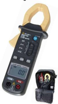
Kompaktes und vielseitig einsetzbares Zangenmultimeter für Gleich- und Wechselströme, Gleich- und Wechselspannungen, Widerstandsmessungen und Durchgangsprüfer. Das Gerät verfügt über ein 3 ¾ digits LCD Display mit einer max. Anzeige von 3999 sowie eine schnelle analoge 42 Segment Bargraphanzeige.
