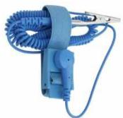
Schützt vor elektrostatischer Aufladung und Funkenbildung. Vermeidet die Zerstörung hochempfindlicher Bauteile wie MOS, CMOS u.a.
