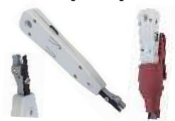
Zum Auflegen und gleichzeitigen Abschneiden von Kabeln auf LSA-Plus-Leisten und Dosen. Pos.E6755 LSA Auflegewerkzeug nur.......... € 9,95
