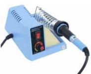
Betrieb an 230V~ 50W, Temperatur regelbar von ca. 150° - 450°C, kurze Aufheizzeit, außenbeheitzte Lötspitze, leicht wechselbar, mit Schwammhalter und beleuchtetem Netzwippschalter.
