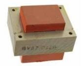
printbare Ausführung, prim.: 220V~, getrennte Kammerwicklungen, Ausgänge 2x15V/2x600mA. Keine Mittelanzapfung Maße: (BxHxT) 60x44x51 mm.
