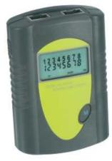
Universeller Kabeltester mit LC-Display zum Testen von ISDN- und Netzwerkkabeln (RJ45 und BNC). Getestet wird Belegung, Abschirmung und Kurzschluss. Bei Verwendung von 2 Kabeltestern können auch bereits verlegte Kabel getestet werden (Master/Slave). Betriebsspannung 4,5 V-, Betrieb über 3x
