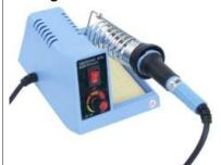
Betrieb an 230V~ 50W, Temperatur regelbar von ca. 150° - 450°C, kurze Aufheizzeit, außenbeheitzte Lötspitze, leicht wechselbar, mit Schwammhalter und beleuchtetem Netzwippschalter.
