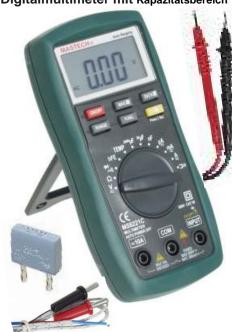
Klassifiziert nach IEC-1010-1, CAT III 600 V 3 1/2-stelliges Digital-Multimeter mit LCD-Display 16 mm Ziffernhöhe und Hintergrundbeleuchtung, rutschfester Soft-Grip Holster mit einklappbarem Aufsteller, Drehschalter zur automatischen oder manuellen Funktions- u. Bereichswahl, akustischer Durchgangsprüfer, Temperaturmessbereich, Überlaufanzeige, automatische Polaritätsanzeige, Data Hold-und Maximalwert-Funktion, berührungssichere 4-mm-Buchsen, Batteriezustandsanzeige, Auto Power OFF Funktion.
