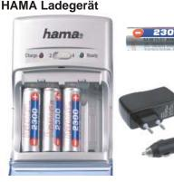
Automatisches Schnell-Ladegerät mit exakter, prozessorgesteuerter Minus-Delta-U-Abschaltung. Ein Überladen der Akkus ist somit ausgeschlossen. So haben Sie immer voll geladene Akkus, die auch im Ladegerät verbleiben können.
