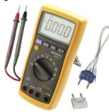
3 %-stelliges Digital-Multimeter MS-8217 mit automatischer-/manueller Bereichsumschaltung , Drehschalter zur Messbereichswahl von Gleich/ Wechselspannung, Gleich/Wechselstrom, Widerstand, Diodentest, Durchgangssummer, Temperatur, Frequenz, Kapazität. Data Hold, LCD Display 3 %- stellig mit 20 mm Ziffernhöhe. Gehäusefarbe schwarz mit gelbem Holster und Aufstellbügel. Gleichspannung: 400mV 4 / 40 / 400 / 1000 V
