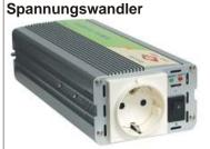
GENIUS Wechselrichter mit hohem Wirkungsgrad und Softstart. Sehr geringe Stromaufnahme im Standby-Betrieb. Ausgangsspannung 230V~/50Hz modifizierter Sinus. Thermischer Überlastschutz, Unterund Überspannungsabschaltung, Low-Bat-Anzeige zeichnen den Wechselrichter aus.
