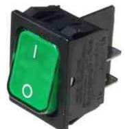
2-polig EIN, mit beleuchteter Wippe, erforderliche Einbauöffnung 30x22 mm.
