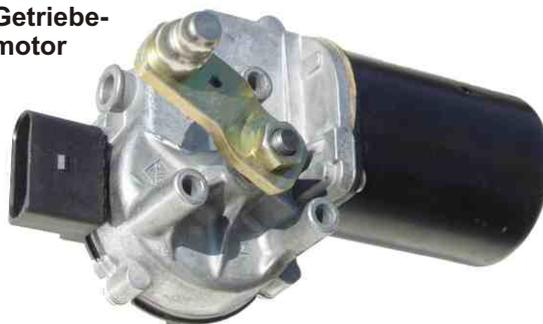
Valeo-Schneckengetriebemotor mit 2-Sufen ca. 60/21 Upm, rechts-/linkslaufend, Betrieb an 12V=/ca. 5A, Motor läuft bereits bei 3V an. Einfache Befestigung an der Getriebe-seite, Antriebsbügel abschraubbar (M8). Maße: (LxHxT) 195x98x 80mm. Pos.E8980 Getriebemotor Valeo 404.587 14,95
