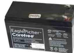
Bleigel Akku, wartungsfreie Ausführung mit 12V 7,2Ah, lange Lebensdauer, lageunabhängig einsetzbar. zB. für Notstromversorgungen, Modellbau, Alarmanlagen, Funk, USV, Solaranlagen. Anschlüsse Faston 4,8 mm.
