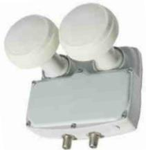
LNB mit festeingestelltem 6°-Abstand zum Empfang von Astra und Hotbird. Integrierter DiSeqC-Schalter. Zum direkten Anschluss von 2 Receivern. Rauschmaß 0,3 dB. Feed-ø 23 und 40 mm. Pos.E8530 nur..... 59,95
