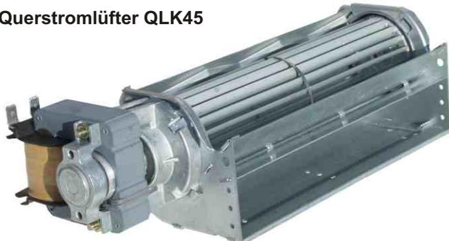
Querstromlüfter QLK45/0018, Betrieb an 380V~50Hz, Walzendurchmesser 45mm, Länge 180mm, für horizontalen Einbau, zulässige Umgebungstemperatur 0 - +60°C, Motor links, Luft - Auslass 31x182mm, Abmessungen ca. Länge 265mm, Tiefe 79mm, Höhe 71mm.
