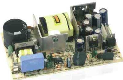
Eingang 90...250 V~. Ausgang +5 V/3 A, +12 V/2 A und -5 V/0,3A. Maße (LxBxH): 127x76x33 mm. Pos.E8950 nur..... 3,95
