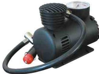
Luft-Kompressor 250PSI. Universell einsetzbar zum Aufpumpen von Reifen oder im Campingbereich. Robustes Kunststoffgehäuse, Manometer, Druckleistung bis zu 18 Bar, Anschluß erfolgt an Zigarettenanzünder Kabellänge 3m, Lieferung mit Adapterdüsen und Nadeladapter, Spannung 12V/10A, Maße 140x80x120mm. Schlauchlänge 400mm.
