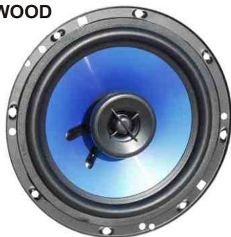
6,5" (165 mm) zwei Wege System blue Line, ausgestattet mit Polypropylen-Membrane Vollgummi-Sicken, Strontium Magnete, Neodymium Hochtöner. Coax, 80 W/4 Ohm, Frequenzgang 70-20000 Hz. SPL 90 dB, Einbautiefe ca. 50 mm, 10 Oz Magnet. Lieferung mit Kabelmaterial und Abdeckgitter. Preis per Paar. Pos.E8955 Zwei-Wege-System nur..... 12,95
