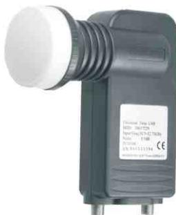
2-fach LNB zum Anschluss von bis zu 2 Receivern (analog oder digital). Rauschmaß 0,5 dB, Feed-Ø 40mm.
