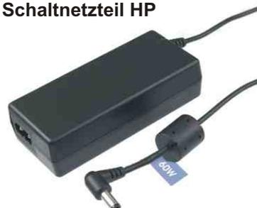
Eingang: 100..240 V~, Ausgang: 19 V-/3,16A. Eingangsseitiger Doppelnutstecker. Ausgang über Anschlusskabel 1,6 m mit Hohlstecker 5,5/2,5 mm.
