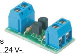
Zum Betreiben von Standard-LEDs an einer Betriebsspannung von 5...24 V-. Durch den konstanten Strom von 20 mA ist eine gleichbleibende Helligkeit und eine maximale Lebensdauer gewährleistet. Desweiteren können mehrere LEDs in Reihe geschaltet werden.
