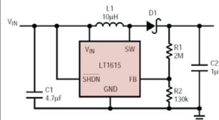
Step-Up Wandler im SOT-23 Gehäuse mit einem Ausgangsstrom bis zu 350 mA, Eingangsspannung 1,2- 15V, Ausgangsspannung bis zu 34V. Ein umfangreiches Datenblatt mit Applikationen finden Sie im online-shop. Typ: LT1615IS5
