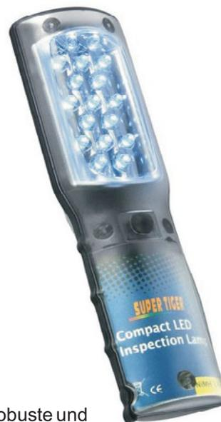
Robuste und kompakte LED-Arbeitsleuchte mit integriertem Akku und Gürtelclip. Durch die 15 superhellen LEDs ideal für Service-Arbeiten am KFZ, Pannenhilfe, Außendienst usw. Passt durch die geringen Abmessungen in jede Hosentasche. Lichtstärke 650 lx/0,5 m. Integrierter NiMH-Akku mit 3,6 V/ 1800 mAh. Lieferung mit 12 V-KFZ-Ladekabel und 230 V-Steckerlader. Maße (BxHxT): 56x185x30 mm. Pos.N4915 nur.....€ 18,95
