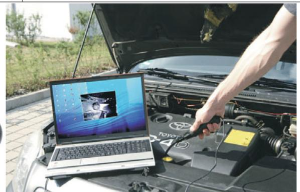
Diese flexible Kamera ist ein Muss für jeden Handwerker, Forscher und Entdecker. Durch den Schwanenhals ist nahezu jede Stelle erreichbar. Durch die dimmbaren LEDs am Kamerakopf bleiben Ihnen auch dunkle Stellen nicht verborgen.
