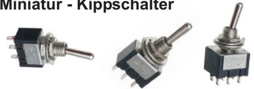
Verchromter Metallknebel, Anschluss über Lötösen. Für einen Befestigungslochdurchmesser von 6mm. Lieferung mit Mutter, Sicherungsring und Scheibe. Schaltleistung 3A/250V~
