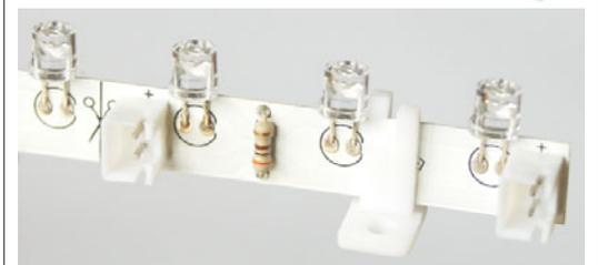
Ideal für direkte oder indirekte Beleuchtung Die Strips sind durch mitgelieferte Verbindungsleitung kombinierbar. Der Strip kann jeweils alle 3 LEDs abgeschnitten und einzeln betrieben werden. Betrieb mit 12 V DC/120 mA (18 LEDs), Länge 30 cm. Inklusive 1 Verbindungsleitung, 5 Befestigungsclips. Maße Strip ca. 16 x 9 mm.
