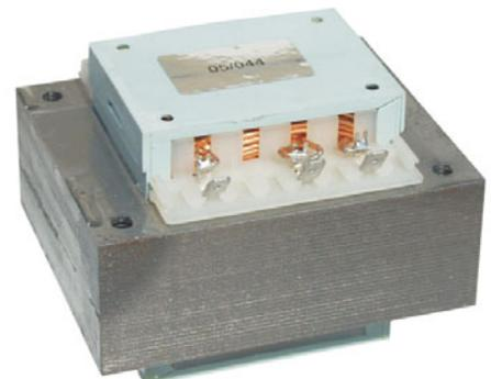
Kräftiger Netztrafo mit 84VA Leistung, Kern EI 84/32 Primär: 230 V / 50- 60 Hz, Sekundär: 0-12- 24 V / max. 3,5A oder auch als 12-0-12 V einsetzbar. Anschlüsse sind Steckfahnen passend für Kabelschuhe mit 4,8 mm. Die Ausführung ist Vakuum getränkt. Abmessungen: (BxTxH) 85x71x65 mm Pos.N3660 per Stk. nur..... € 7,95
