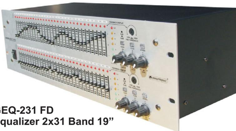
2x31-Band Equalizer mit Feedback-Display. Über den Bereichsschalter lässt sich die Anzeige von +/- 6dB auf +/- 15dB umschalten. EQ-In/Out Schalter zum schnellen Vergleich des Sounds mit bzw. ohne Equalizer Hi Cut (4-30kHz) und Low Cut (30-300Hz) mit 6 dB/Okt.
