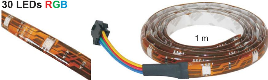
selbstklebend mit 30 RGB-LEDs (Typ 5050) und spritzwasserfest nach IP64. Ideal für direkte oder indirekte Beleuchtung. Es kann alle 3 LEDs abgeschnitten und einzeln betrieben werden. Betrieb mit 12V DC 600mA (200mA je Farbe). Länge 1m. Strip ca. 10x2.1mm. Einfach zum Reinigen. (passend zu RGB-Controller).
