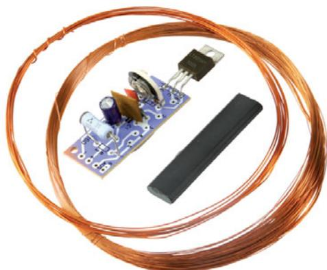
Mit diesem Spannungswandler können Leuchtstofflampen (8...40 W) direkt an der 12 V-Autobatterie betrieben werden. Ideal für Camping, Wochenendhäuser usw.
