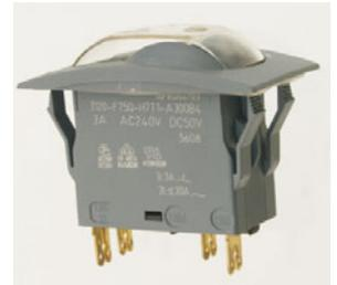
Kombination Schutzschalter/ Ein-Aus-Schalter mit Schaltwippe, Einbauöffnung 50,5 x 21,5 mm. 250V~/DC50V
