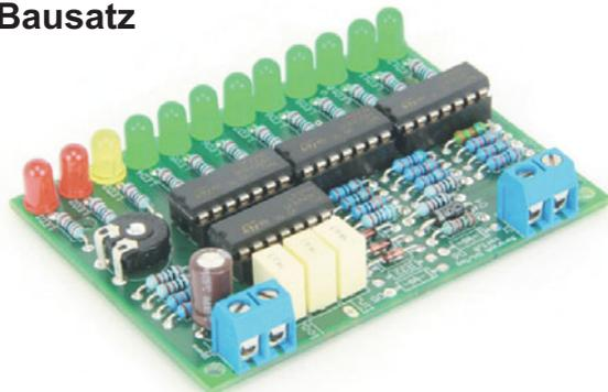
Mit diesem VU-Meter-Bausatz ist es möglich, NF-Aussteuerungssignale oder Spannungen bis 24 V- mittels 12 Leuchtdioden optisch anzuzeigen. Mit einem Trimpotentiometer kann der Bausatz dem jeweiligen Verwendungszweck einfach angepasst werden. Betrieb an 12 V-/190 mA, Messspannung ca. 0,7...12 V~ log. oder 3...24 V-. Platinenmaße (LxBxH): 77x57x16 mm. Pos.N4815 VU-Meter Bausatz nur..... € 4,95
