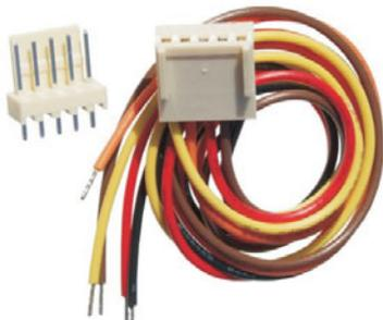
Platinensteckverbindersatz, RM 2,54, Buchsenleiste mit Anschlussleitung ca. 300 mm lang, fest verdrahtet. Litzen mehrfarbig im internationalen Farben-Code. Belastbarkeit max. 250 V/3A AC/DC. Steckerleiste gerade für vertikale Printmontage.
