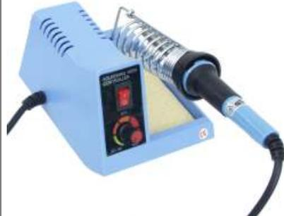
Betrieb an 230V - 50W, Temperatur regelbar von ca. 150° - 450°C, kurze Aufheizzeit, außenbeheizte Lötspitze, leicht wechselbar, mit Schwammhalter und beleuchtetem Netzwippschalter.
