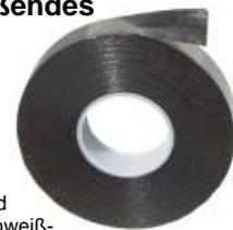
Geignet für Reparaturen am Kabel-, Isolation und Abdichtung von Steckverbindern, F-Steckern, Schläuchen, Schutz von Metallrohren gegen Korrosion, Isolierung von Hebeln. Temperaturbeständigkeit -40...+90 °C. Das Band zeigt ausgezeichnete selbstverschweißende Eigenschaften, verschweißt sofort unter Zug zu einer homogenen luftleeren Isolierung und ist durch Aufschneiden leicht und sauber zu entfernen. Rollenbreite 19 mm, Länge 10 m. Pos.E7105 per Rolle nur..... € 6,95
