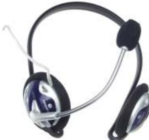
Mikrofon Kopfhörer Kombination mit Schwannenhals-Mikrofon geeignet zum Anschluss an jede Soundkarte, sorgt für glasklaren Sound in allen Anwendungsbereichen. Der Backphone-Kopfhörer bietet höchsten Tragekomfort. Anschluss über 2x 3,5 mm Klinenstecker (Hörer und Mikrofon), hochwertiges textilummanteltes Kabel 2 m, integrierter Lautstärkeregler für Hörer, Impedanz 32 Ohm, Freq. 20...20000 Hz Mikrofon Omni-Direktional Empfindlichkeit -58 dB, 30...16000 Hz
