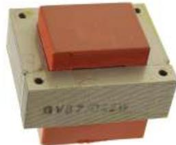
printbare Ausführung, prim.: 220V~, getrennte Kammerwicklungen, Ausgänge 2x15V/2x600mA Keine Mittelanzapfung
