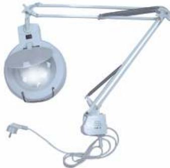
Die ideale Kombination von Lupe und Kaltlicht ermöglicht langes, ermüdungsfreies Arbeiten. Allseitig verstellbar durch Federgelenkarme, dadurch haben Sie immer beide Hände frei. Arbeitsradius ca. 1m. Eine Ringleuchtstoffröhre mit 22 Watt sorgt für eine gute Ausleuchtung der Arbeitsfläche ohne Erwärmung. 3-Dioptrien Glaslinse (120mm). Wipp Ein/ Ausschalter. Farbe hellgrau, mit Tischklemme und Anschlusskabel.
