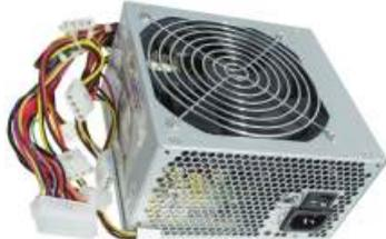
Hochwertiges, leises 350 Watt Schaltnetzteil mit 120 mm Lüfter. Durch die Standardabmessungen (BxHxT): 150x85x140 mm) passend für fast alle Computergehäuse. Type FSP350-60MDN. Technische Daten: Eingangsspannung: 230 V~, Ausgangsspannungen: +3,3 V/28 A, +5 V/30 A, +12 V/19,5 A, +5 VSB/2 A, -5 V/0,3 A, -12 V/0,5 A
