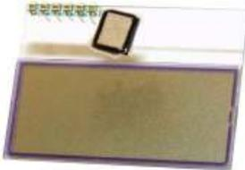
Alphanumerische LCD Punktmatrix Anzeige von Philips, 3 x 12 Zeichen, I2C-Bus Interface, nur 2,85mm flach, Spannungsversorgung 5V/700µA, Transflectiv kann von hinten beleuchtet werden. Zeichenhöhe 4,68mm. Maße: 46x33,25x3 mm. Pos.E7155 per Stk. nur €4,95
