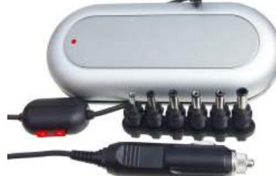
z.B. für Notebooks. Schaltnetzteil, Spannungswandler, Ausgangsspannung 15 – 24 V DC. Der DC-Anschluss erfolgt über sechs verschiedene DC-Adapter (Polarität nicht änderbar), die für die gängigsten Notebooks und andere Niederspannungsgeräte geeignet sind. Technische Daten: Eingang: 12 – 13,8 V DC, Ausgang: 15 / 16 / 18 / 19 / 20 / 22 V max. 3500 mA, 24 V max. 3000 mA
