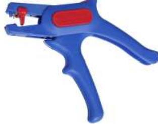
vollisolierte automatische Abisolierzange für alle gängigen flexiblen und massiven Leiter von 0,2 - 6,0qmm, einstellbarer Längenschlag von 5-12mm, bei Bedarf herausnehmbar, integrierter, gut zugänglicher Seitenschneider bis 2mm. Pos.E2780 .... €14,90
