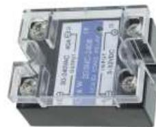
Elektronisches Lastrelais, Type ZG3NC-240B Schaltleistung (1-polig) 40A/30-240VAC, Steuerspannung Eingang 3-32V DC mit Schaltzustandsanzeige über LED, Abmessungen LxTxH 58x45x32mm, Lieferung mit Abdeckhaube.
