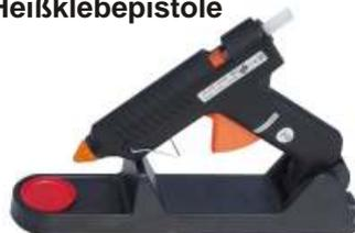
Handliche Heißklebepistole mit Ständer Ladestation zum kabellosen Arbeiten. Dadurch ist ein flexibles Arbeiten möglich. Für Standard Klebesticks mit 11 mm Ø. Betriebsspannung 110...240 V~, Anheizleistung / Betriebsleistung 100 W/28 W, Länge der Klebepistole 190 mm, Länge der Tischhalterung 295 mm.
