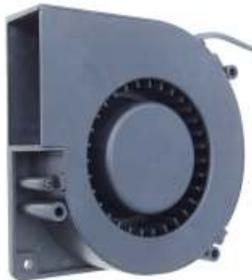
Radiallüfter ADDA AD2512MB Leistungsstarker Lüfter zum Kühlen von Ladegeräten, Netzteilen usw.. Betriebsspannung 12V / 0,6A, Luftaustrittsöffnung 56x28mm, Abm 120x120x32 mm
