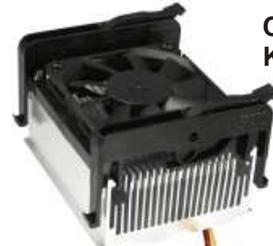
Leistungsstarker und laufruhiger CPU-Kühler für Intel Pentium 4/Celeron CPUs bis 2,4 GHz. Die Lüfter sind gebraucht, waren jedoch kaum in Betrieb. Leichte Gebrauchsspuren möglich! Technische Daten: Betriebsspannung 12 V-, Leistung 2,8 W Drehzahl 4800 U/min, Geräusch 34,5 dB(A), Luftmenge 32,26 Kubikmeter/h, Lüftermaße: 60x60 mm, Gesamtmaße (LxBxH): 83x73x60 mm. Pos.E7950 CPU-Kühler nur..... €1,50
