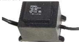
Netztrafo vergossen, mit 115 cm langem Euronetzkabel mit Stecker. Ausgänge über 110cm Rundkabel 4x0,5qmm. Eingangsspannung 220V~, Ausgang 24V~/0,8A und 8V~/0,5A. Maße 55x82x58mm.
