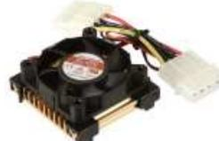
Hochleistungs-Kühler mit kupferfarben eloxiertem Kühlkörper, ideal zur Kühlung von Prozessoren und Peltier-elementen. Betriebsspannung 12 V-/80 mA, Anschlussleitung 280 mm mit 5,25"-Laufwerkstecker. Maße 49,5x49x19 mm Lüftermaße 45x45x10 mm.
