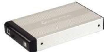
Externes Aluminium-Gehäuse zum Betrieb von handelsüblichen 3,5" IDE-Festplatten am USB-Port. Kompatibel mit USB 2.0 und USB 1.1. Treiberinstallation nur unter Windows 98 notwendig. Ab Windows ME automatische Treiberinstallation. Technische Daten: - Übertragungsgeschwindigkeit max. 480 Mbps - geeignet für Festplatten bis 280 GB - Ein/Aus-Schalter Maße (LxBxH): 200x108x33 mm. Lieferumfang: Gehäuse, Schaltnetzteil, USB-Kabel, Montagematerial, Treiber. Pos.E7935 per Stk. nur..... €15,95
