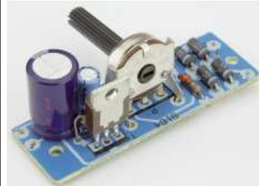
Kompaktes, elektronisch regelbares Netzteil für 0...12 V- Ausgangsspannung und einen maximalen Strom von 800 mA. Ideal für Werkstatt, Modellbau usw. Zum Betrieb ist noch erforderlich: 1 Netztrafo 15 V~/> 800 mA und ein Kühlkörper mit den Mindestmaßen 30x70x15 mm. Pos.E8250 Bausatz nur.. €1,95
