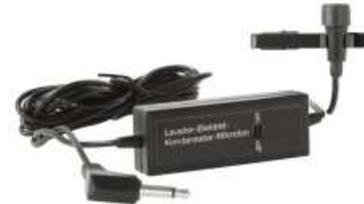
Ansteck-Mikrofon. Ultrakleines Lavalier-Electret-Kondensator-Mikrofon mit Batteriespeisegerät, ideal für Sprachübertragung bzw. Sprachaufnahmen im Audio- und Videobereich. Technische Daten: Frequenzbereich 50-16000Hz, Impedanz 1000 Ohm, Charakteristik Kugel, Stromversorgung SR44, Anschluss Klinke 3,5mm, Anschlusskabel ca. 3m mit integriertem Batterie-/Schalterkasten, mit Ein-/Aus Schalter, Maße des Mikrofons ca. LxD 21x8mm.
