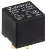
Spule 12 V/ 80Ohm Anschlüsse 85/86, 1 Schließer (Anschlüsse 30/87), Schaltleistung 40 A/12 V, Anschlüsse über 6,3 mm Flachstecker. Maße (BxHxT): 28x25x28 mm.
