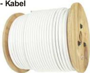
Digitaltaugliches, dämpfungsarmes Koaxialkabel mit Metermarkierung für SAT-TV-Anlagen mit 75dB Schirmungsmaß, Innenleiter 1,1mm, Dämpfung bei 1750MHz 25dB und bei 2250MHz 28dB, Schirmung: doppelte Alufolie und Geflecht, für 7mm F-Stecker, Farbe ws.
