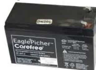
Bleigel Akku, wartungsfreie Ausführung mit 12V 7,2Ah, lange Lebensdauer, lageunabhängig einsetzbar. zB. für Notstromversorgungen, Modellbau, Alarmanlagen, Funk, USV, Solaranlagen. Anschlüsse Faston 4,8 mm.
