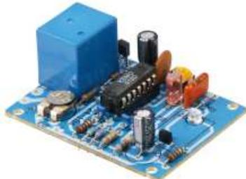
Dieser optische Rauchmelder schaltet ein Relais, wenn dicker Rauch zwischen die Infrarot-Lichtschranke kommt. Mit dem Relais können dann Sirenen, Lampen usw. geschaltet werden. Betriebsspannung 12 V-max. 150 mA, Relais-Schaltleistung 3 A/250 V~. Maße (LxB): 58x45 mm. Pos.E8030 Bausatz nur..... €3,20
