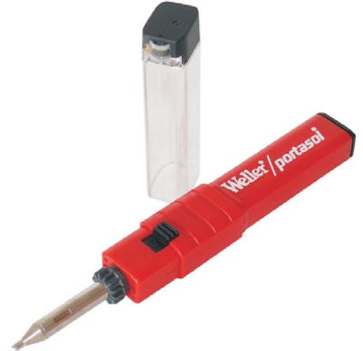
Gaslötkolben vom Markenhersteller Weller. Mit langer Lebensdauer durch hochwertige Lötspitze. Aufheizzeit von 50 °C auf 350 °C in ca. 70 Sekunden. Max. Temperatur 375 °C. Betrieb mit konventionellem Feuerzeuggas (nicht im Lieferumfang). Lötspitze Meißelform 4 mm. Integrierter Starter in der Abdeckkappe. Ideal für den mobilen und schnellen Einsatz. Maße: ca. 195 x 26 x 18 mm. Pos.N5130 Gaslötkolben € 7,95
