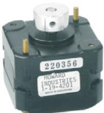
Unipolarer, kugelgelagerter Steppermotor mit hohem Drehmoment und kompakten Maßen. Schrittwinkel 3,6° (100 Schritte), Betrieb an 24 V-, Strangwiderstand 140 Ohm, Strangstrom 160 mA, Motormaße ohne Welle 35x42x42 mm, Welle (LxØ): 10x5 mm. Pos.N5115 € 2,95
