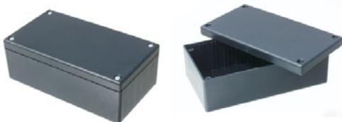
Bodenteil mit vier Aufnahmebefestigungen für Leiterplatten. Gehäuseoberteil mit Führungsschlitzen zur Befestigung von Leiterplatten. Gehäuse- Wandstärke ca. 1,8 mm. Gehäusefarbe schwarz. Im Lieferumfang sind 4 Befestigungsschrauben zur Befestigung des Gehäusedeckels enthalten. Pos.PB-103 (LxBxH) 115x60x44 mm nur.....€ 3,60 Pos.PB-113 (LxBxH) 35x75x49 mm nur.....€ 3,60 Pos.PB-123 (LxBxH) 160x95x62 mm nur.....€ 4,30
