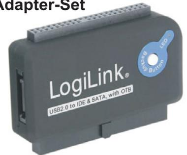
Mit diesem Adapter lassen sich 2,5" oder 3,5" IDE- und SATA-Geräte (Festplatten, CD-Laufwerke usw.) am USB-Port betreiben. Die Stromversorgung der 2,5"-Festplatten erfolgt über den USB-Port, die der 3,5"-HDDs durch das mitgelieferte Netzteil. **Technische Daten:** USB 2.0 (kompatibel zu USB 1.1) ab Windows 98SE. Lieferumfang: USB-Adapterkabel, Netzteil, Anschlusskabel, Treiber-CD, Anleitung. Pos.N4280 € 14,95
