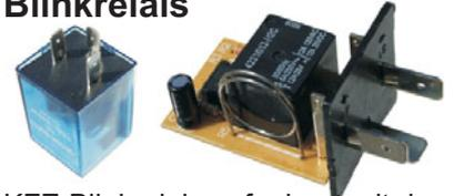
KFZ-Blinkrelais aufgebaut mit dem IC U2043B und einem Relais. Schaltleistung 12A, Anschlüsse sind 31(-) 49(+) 49a(+) Ausgang für die Lampen gegen Masse. Pos.N3655 Blinkrelais nur.... € 1,95
