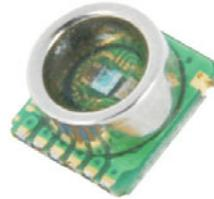
Das HP03S-Luftdruckmodul verfügt über einen Piezo-resistiven Sensor und einer 16 Bit ADC-Schnittstelle (Luftdruck/Temperatur). Über das I<sup>2</sup>C-Interface ist eine einfache Ansteuerung mit einem Microcontroller möglich.
