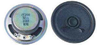
Impedanz 32 Ohm, Belastbarkeit 0,5 Watt, Frequenzbereich 420-5000Hz, Durchmesser 50mm, Einbautiefe 18mm.
