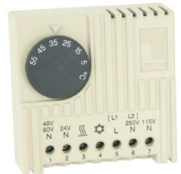
Regelbereich 5...55 °C Schaltkontakt: 1 Wechsler, daher geeignet für Kühl- und Heizgeräte. Sehr geringe Schaltdifferenz durch thermische Rückführung. Betriebsspannung 24, 48, 60, 115 und 230 V~, Schaltleistung Heizbetrieb (Kontakt 5-3): 10(4) A bei Kühlbetrieb (Kontakt 5-4): 5(4) A, geeignet zur Montage auf 35 mm-Tragschienen. Zur Steuerung von Heizungen, Wärmetauschern, Klimageräten, Lüftern. Maße: 71x71x33,5 mm. Pos.N5100 € 9,95
