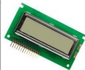
2-zeiliges Text-Display mit Controller HD44100H. Durch die Printkontakte kann dieses Display einfach auf eine Loch- oder Streifenrasterplatine montiert werden. Technische Daten: 2 Zeilen x 16 Zeichen Text integrierter Controller, Industriestandardkompatibel, Ansteuerung über 4-Bit- oder 8-Bit-Datenbus, 8 benutzerdefinierte Zeichen bei einer Zeichengröße von 2,95x4,85 mm, Betriebsspannung +5 V, Anzeigefläche 61x15,8 mm. Maße (BxHxT): 84x44x10 mm. Pos.E7385 nur..... €4,95
