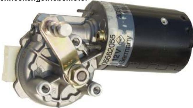
SWF-Schneckengetriebemotor mit ca. 120 Upm, rechts-/linkslaufend, Betrieb an 12V=ca. 6A, Motor läuft bereits bei 3V an. Einfache Befestigung an der Getriebeseite mit 3x M6-Gewindebuchsen, Antriebsbügel abschraubbar (M8). Maße: (LxHxT) 175x98x80mm. Pos.E7240 Getriebemotor per Stk. nur..... €12,90
