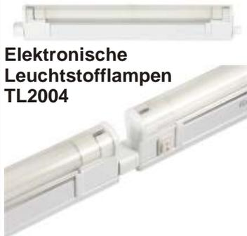
PLatzsparende Langfeldleuchten mit nur 19 mm Bauhöhe, Tiefe = 43 mm, Länge je nach Leistung. Geeignet für liegende oder stehende Montage. Durch beidseitige Steckverbinder können die Leuchten direkt zusammengesteckt werden. Eingebauter Netzwickelschalter, Lichtfarbe weiß. Lieferumfang: Leuchte, 4 Halteclips (2x90°), T4/G5-Leuchtmittel, Netzkabel und Verbindungskabel. Betrieb an 230V~
