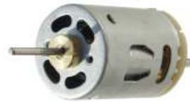
Hochleistungs-Gleichstrommotor mit 4-teiligem Anker, Hohe Lebensdauer, Betriebsspannung 6-12V/ ca. 270mA, 3000-9500 Upm. Abmessungen Gehäuse-Ø 28mm, Länge 42mm, Welle-Ø 2,3mm, Länge 19,5mm. Zur Befestigung sind an der Stirnseite zwei M2,5 Gewindebuchsen. Pos.E7235 nur..... € -,95
