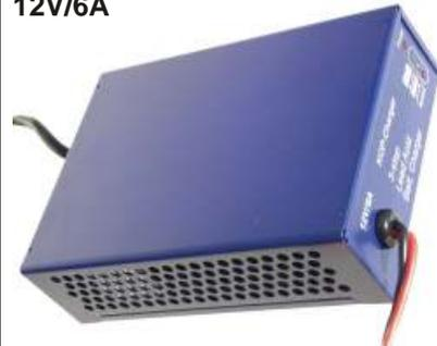
Automatisches Ladegerät mit hohem Wirkungsgrad (Schaltnetzteiltechnik) für Bleiakkus. Die Hauptmerkmale sind getaktetes Ladegerät, automatischer Betrieb mit optimierten Ladevorgang, hoher Wirkungsgrad, kompaktes Tischgerät mit 230V Netzanschluß, Kurzschluß und verpolungsgeschützt, Betrieb und Diagnostikanzeige mit 3 LED's. Netzschalter auf der Rückseite. Lieferung mit Batterieladekabel. Maße: (LxBxH) 160x118x48 mm. Pos.E6375 Bleigel-Lader 12V/6A ..... €39,95
