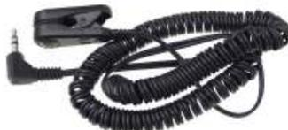
IR-Puls-Sensor für Ergometer mit ca. 2 m langem Spiralkabel (ausgezogen). Als Ersatzteil, für Versuche oder zum Basteln ein sehr interessantes Bauteil. Die Lichtschranke ist im Klipp vorne eingebaut. Der Anschluss am Klinkenwinkelstecker ist: ganz vorne + LED/10mA, in der Mitte Kollektor Transistor 2mA, hinten gemeinsame Masse. Bitte nicht den Vorwiderstand vergessen! Tipp: kann auch zur Überwachung von Flüssigkeiten im Schlauch verwendet werden. Pos.E5850 per Stk. nur..... €2,95
