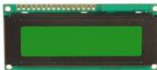
Display Modul grün mit Hintergrundbeleuchtung, Standard Ausführung 2x16 Zeichen, Inline Anschluß 16-polig, wobei Pin 15+16 die Hintergrundbeleuchtung ist. Betrieb an +5V, TTL und 5V CMOS kompatibel, Schnittstelle für Mikroprozessor-Bus. Außen-maße 80x36mm, Display 61x15,8mm
