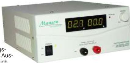
für sehr hohe Ausgangsströme bis zu 40A. Die Ausgangsspannung läßt sich zwischen 3V und 15V kontinuierlich einstellen, oder über einen Schiebeshalter an der Unterseite, kann auch auf eine Fixspannung von 13,8V geschaltet werden. Digitale Strom- und Spannungsanzeige. Überlast- und Kurzschlußfest (optische Anzeige). Betrieb an 230V~. Maße:(B/H/T) 220x110x300mm, Gewicht 3,5Kg. Ideal als Stromversorgung für die Funktechnik, im Laborbereich und Werkstättenbereich. Pos.H642 nur..... €124,90
