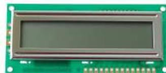
1-zeiliges Industrie - Display mit Controller Standardausführung 1x16 Zeichen, inline Anschluß 14 pin, Type BATRON TN11605. Maße 36x80mm, Anzeigefläche 13x64mm. Betriebsspannung +5V und ca. -1,5V, 4 oder 8bit Ansteuerung. Lieferung mit Anschlussbelegung und Schaltung zur einfachen Erzeugung der negativen Spannung. Ideales Display für Bastelzwecke.
