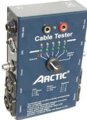
Kabeldurchgangs-Prüfer für Audioleitungen. Zum Testen von Cinch-, 6,3mm Klinken-, 5-poligen DIN-Phono-, XLR 3-polig (Stecker-Kupplungen) und PA-Kabeln. Mit integrierten akustischen Durchgangsprüfer. Im robusten Metallgehäuse. Betrieb mit 9V Batterie. (nicht im Lieferumfang enthalten) Maße 140x110x45mm. Pos.E7400 €19,90
