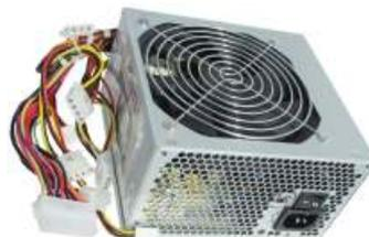
Hochwertiges, leises 350 Watt Schaltnetzteil mit 120 mm Lüfter. Durch die Standardabmessungen (BxHxT): 150x85x140 mm) passend für fast alle Computergehäuse. Type FSP350-60MDN. Technische Daten: Eingangsspannung: 230 V-, Ausgangsspannungen: +3,3 V/28 A, +5 V/30 A, +12 V/19,5 A, +5 VSB/2 A, -5 V/0,3 A, -12 V/0,5 A Pos.E6635 per Stk. nur..... €14,95
