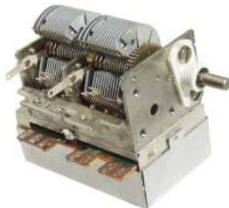
UKW - Mischteil mit einer ZF von 10,7 MHz, Eingang 240 Ohm, Frequenzbereich 87,5 - 104 MHz. Drehkondensator 2 x 320 pF/2x12 pF mit Feintrieb und verspanntem Zahnrad, Ub 12V~, AFC.
