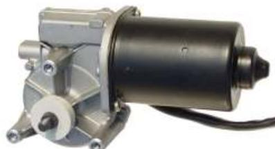
SWF-Schneckengetriebemotor mit zwei Geschwindigkeiten ca. 38/60 Upm, rechts-/linkslaufend, Betrieb an 12V~/ca. 4A, Motor läuft bereits bei 3V an. Einfache Befestigung an der Getriebeseite, 3 x M6-Gewindebuchsen, Antriebswelle mit Konus und M8 Gewinde. Maße: (LxHxT) 175x98x80mm. Pos.E7305 per Stk. nur .....€ 9,95
