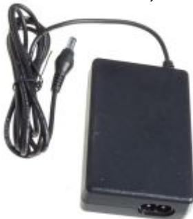
Hersteller Fa. ASTEC, Modell SA35-3159 (Eing. 100-240V AC, Ausg. 24V DC, max. 1,46A). Gerät ist schutzisoliert, mit CE-Zeichen, Ausgangsleitung 1,5m auf Hohlstecker. Eingang über 2-polige Eurobuchse. Anschlußbelegung ist aufgedruckt.
