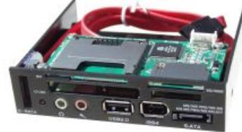
Frontpanel mit schwarzer Blende zum Einbau in einen 3,5" Laufwerksschacht. Mit folgenden Anschlüssen SATA, eSATA, USB 2.0, FireWire, Audio. Integrierter Card-Reader zum Lesen und Beschreiben aller gängigen Speicherkarten (z.B. SD, MMC, CF I/II, MD, MS, MS Pro, MS Duo ...). USB 2.0 (kompatibel zu USB 1.1), LED Statusanzeige, ab Windows 98SE
