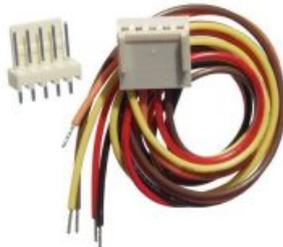
Platinensteckverbindersatz, RM 2,54, Buchsenleiste mit Anschlussleitung ca. 300 mm lang, fest verdrahtet. Litzen mehrfarbig im internationalen Farben-Code. Belastbarkeit max. 250 V/3A AC/DC. Steckerleiste gerade für vertikale Printmontage.
