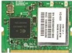
Wireless LAN Karte X-603 zum Betrieb in Laptops, Routern, Multimedia-Boxen usw. mit mini PCI-Schnittstelle.
