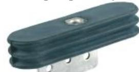
Aus Weichgummi, mit 2 Bohrungen  $\varnothing$  11 mm, 1/4"-Gewindeinsatz und Metallplatte, ideal zur gedämpften Aufhängung von Motoren, Pumpen, Lautsprechern usw.
