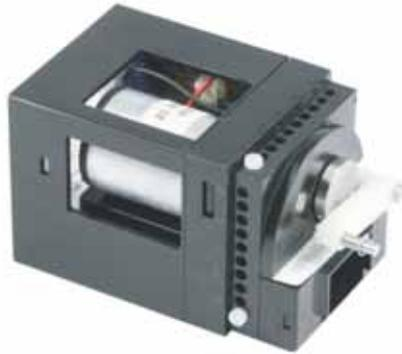
Gleichstrommotor im Kunststoffrahmen mit Getriebe, Exzenter-scheibe und Pendelarm, ideal für Modellbau, kleine Pumpen, Linearantriebe usw. Hubweg 20 mm, Hubzahl ca. 100...200 U/min. Betriebsspannung 12...24 V/ca. 0,2 A. Maße (LxBxH): 90x50x50 mm.
