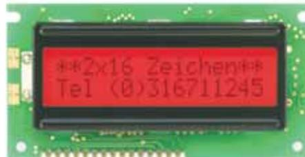
2x16 Zeichen mit roter LED-Hintergrundbeleuchtung, Betrieb an 5V-, integrierter Controller (Industriestandardkompatibel), einfacher Anschluss über 16-polige Stiftleiste, sichtbarer Bereich 63,5x15,8 mm.
