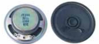
verwendbar als Lautsprecher oder Mikrofon, besonders gut geeignet für Wechselsprechanlagen oder Funkgeräten. Impedanz 32 Ohm, Belastbarkeit 0,5 Watt, Frequenzbereich 420-5000Hz, Durchmesser 50mm, Einbautiefe 18mm.
