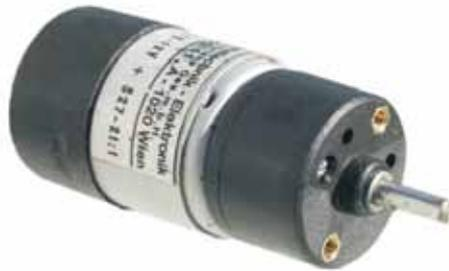
DC-Motor mit Getriebe Typ M27x15/S, Betrieb an 12V, Leerlaufstrom 60mA, 160 Upm, Last max. 200mA 115Upm, Drehmoment 7,5 Ncm. Motor-Ø 30mm, Länge ca. 60mm, Achs-Ø 4mm Länge 11mm, zur einfachen Befestigung gibt es an der Stirnseite zwei Gewindebuchsen M3. Pos.N4160 € 5,95
