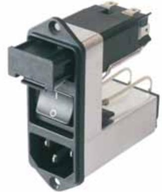
Schurter Gerätestecker-Kombi-Element CD 14.4101.151 mit Netzfilter (LC-Glied 68nF X2, 2x10mH, 2x2,2nF), 2-poliger Wippschalter. Lieferung inkl. Sicherungsschacht (für 2 Sicherungen 5x20mm). Max. Strom 1A, Einbautiefe ca. 68mm, LxB ca. 84x30mm. Pos.N4015 Kombi-Element nur € 3,95
