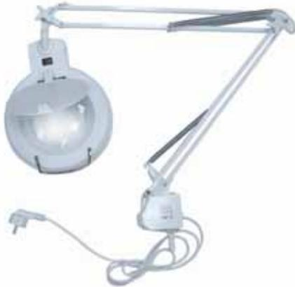
Die ideale Kombination von Lupe und Kaltlicht ermöglicht langes, ermüdungsfreies Arbeiten. Allseitig verstellbar durch Federgelenkarme, dadurch haben Sie immer beide Hände frei. Arbeitsradius ca. 1m. Eine Ringleuchtstoffröhre mit 22 Watt sorgt für eine gute Ausleuchtung der Arbeitsfläche ohne Erwärmung. 3-Dioptrien Glaslinse (120mm). Wipp Ein/ Ausschalter. Farbe hellgrau, mit Tischklemme und Anschlusskabel. Pos.H657 nur € 34,95
