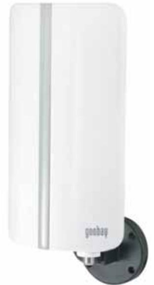
Universell montierbare Antenne mit integriertem Verstärker. Geeignet für VHF/UHF und UKW. Stationär und mobil einsetzbar. Wasserdicht und UV-beständig. **Technische Daten:** Betriebsspannung 5 V/30 mA (über Antennenspannung des Receivers), Verstärkung 20 dB Frequenzbereich 47...230 MHz und 470...870 MHz, Polarität vertikal/horizontal, universell an Wand oder Mast montierbar
