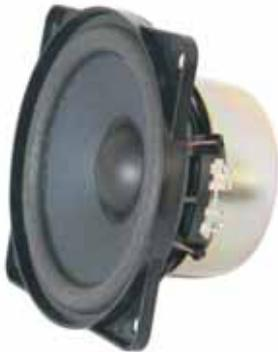
Hochwertiges Bass-Chassis mit schlagfestem ABS-Korb, Schaumstoff-Sicke, für den Einsatz in 2- oder 3-Wege-Systeme, Impedanz 8 Ohm, Sinus-/Musikleistung 25/-50W, Frequenzbereich 60-7000Hz, Korbdurchmesser 114mm, Lochkreisausschnitt 106mm.
