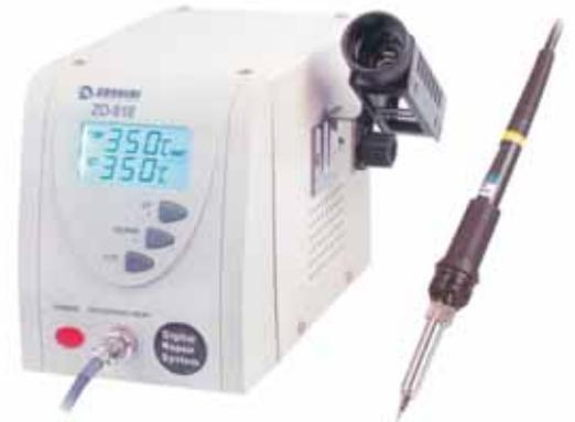
Speziell entwickelte Lötstation für bleifreies Löten, Regelbarer Temperaturbereich von 160-480°C der über ein LCD-Display angezeigt wird, Aufheizzeit bis zu 380°C innerhalb von 30Sek., Lieferung mit LötKolbenständer und Longlife Lötspitze, Betriebsspannung 230VAC /50Hz, LötKolbenspannung 24V, Leistung 60-130W, Maße LxTxH 220x220x280mm.
