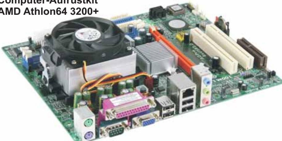
Fertig montiertes PC-Aufrüstkit mit hervorragend ausgestattetem Mainboard (ECS GS7610 Ultra), AMD CPU und Kühler. Ideal zum Aufrüsten von älteren Rechnern oder zum Bau von kostengünstigen neuen Systemen.
