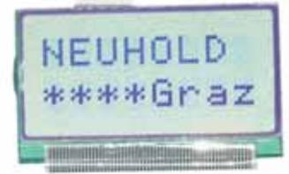
2-zeiliges LC-Display mit 8 Zeichen pro Zeile und Industriestandard-kompatiblen Controller (HD47780 kompatibel). Der Anschluss erfolgt wahlweise über das 10-polige Flachband-Kabel oder über Lötunkte. **Technische Daten:** Betriebsspannung 5V- Anzeigefläche 44x23 mm Zeichengröße 5x3 mm, Ansteuerung über 4-Bit-Datenbus. Maße (BxHxT): 45x26x5 mm
