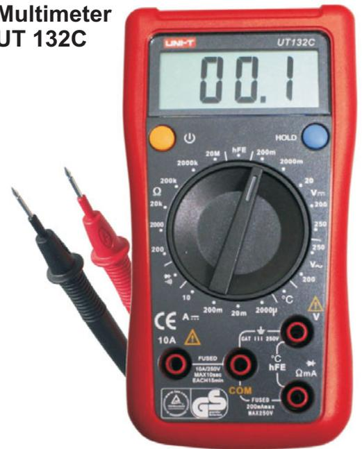
Digital-Multimeter nach IEC/EN61010-1 CAT III 250 V, GS Prüfzeichen. 3 1/2-stelliges Digital-Multimeter mit LCD-Display, 15 mm Zifferhöhe, einklappbarer Aufsteller. Drehschalter zur Funktions- und Bereichswahl, akustischer Durchgangsprüfer, Temperaturmessbereich, Dioden/Transistortest, Überlaufanzeige, automatische Polaritätsanzeige, Data Hold- Funktion, berührungssichere 4-mm-Buchsen, Batteriezustandsanzeige.
