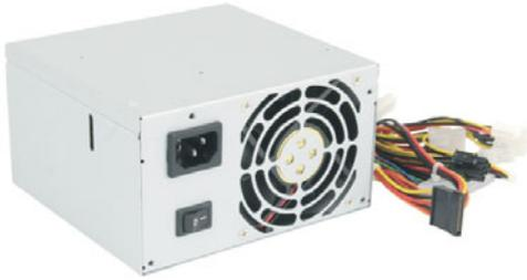
Dieses ATX2.0-Schaltnetzteil (P4/PFC) mit Standardmaßen (BxHxT): 150x85x140 mm ist passend für fast alle Computergehäuse. Leistung max. 500 W. Eingang: 230 V~, Ausgang: +3,3 V/26 A, +5 V/36 A, +12 V/24 A, -12 V/0,8 A, -5 V/0,5 A, +5 VSB/2 A. Anschlüsse: 24-Pin ATX. Pos.N5310 € 16,95
