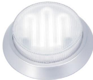
Silberfarbene, sehr einfach zu montierende Energiespar-Aufbauleuchte mit der neuen GX53 Energiesparlampe. Ideal zur Montage an der Decke, an Möbeln usw. Betriebsspannung 230 V~/7 W (entspricht der Lichtleistung einer herkömmlichen 40 W Glühlampe). Leuchtmittel-Lebensdauer max. 5000 h, Netzkabel mit Eurostecker, Länge 1,5 m. Maße (øxH): 100x26 mm. Lieferumfang: Aufbau-Rahmen mit Kabel, Leuchtmittel, Schrauben. Pos.N5360 € 7,95
