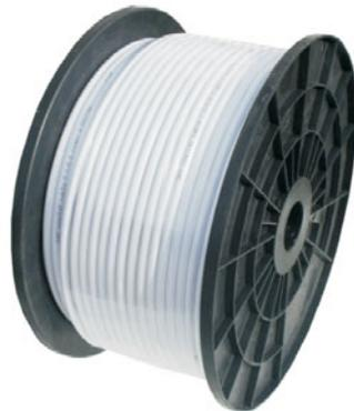
Digitaltaugliches, dämpfungsarmes Koaxialkabel mit Metermarkierung für SAT-TV-Anlagen mit >90dB Schirmungsmaß, Innenleiter 1,1mm, Dämpfung bei 1750MHz 25dB und bei 2250MHz 29dB, Schirmung: doppelt Alufolie und Geflecht, für 7mm F-Stecker, Farbe ws. Pos.N5455 100m Rolle nur € 21,95
