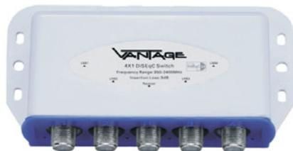
Marken DiSEqC-Schalter mit wirksamen Wetterschutz und Bohrungen für einfache Montage an der Wand oder am Antennenrohr. Zum Umschalten zwischen 4 Satelliten. **Technische Daten:** 4 Eingänge/1 Ausgang, DiSEqC 2.0, Frequenzbereich 950...2400 MHz, Stromverbrauch nur 10 mA, Durchgangsdämpfung 3 dB, Betriebs-Temperaturbereich -20...+60 °C Maße (BxHxT): 112x77x30 mm. Pos.N5460 nur..... € 5,95
