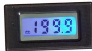
Digitales 3 1/2 stelliges LCD Voltmetermodul, 13mm Ziffernhöhe, schaltbare blaue Hintergrundbeleuchtung max. Eingangsspannung +/- 199,9m VDC, Eingangswiderstand >100MOhm, Betriebsspannung 8-12VDC und ca. 1mA ohne Beleuchtung, Dezimalpunkt setzbar, Anschlußbelegung und eine Tabelle für Spannungs-/ Stromerweiterung liegt bei. Außenmaße (LxBxT) 79x43x17mm, Frontplattenausschnitt 70x39mm. Pos.N0675 nur..... €5,95
