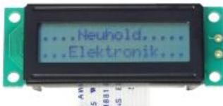
LCD-Displaymodul mit 2 x 16 Zeichen, Anschluss über 16-polige Flachbandleitung. Betrieb an +5V, TTL und 5V CMOS, Schnittstelle für Mikroprozessor-Bus kompatibel zu HDD44780,
