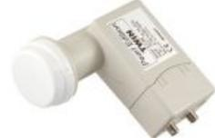
2-fach LNB zum Anschluss von bis zu 2 Receivern (analog oder digital). Jederzeit analog erweiterbar mit Multischalter. Rauschmaß 0,3 dB. Feed-ø 40 mm.
