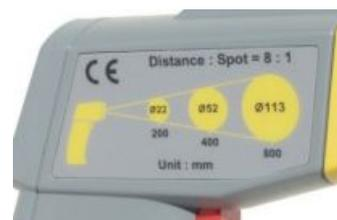
Infrarot-Thermometer zum berührungslosen Messen von Oberflächentemperaturen, besonders robustes Gehäuse, einfach zu bedienen, mit Laserstrahl zum genauen Anpeilen des Messpunktes. Ansprechzeit 0,5 Sekunden, Beleuchtetes 4-stelliges LCD Display, Anzeige der aktuellen Temperatur, Messbereich -20...+500°C, umschaltbar °C/°F, Genauigkeit 2 % vom Messwert Verhältnis Messentfernung/Messfleckgröße 8:1. Im Lieferumfang sind 9V Batterie, Tragetasche und Deutsche Bedienungsanleitung enthalten.
