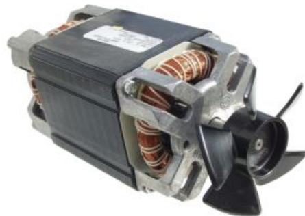
1~ Motor 230V/50Hz 200W, 2690 Upm, Kondensator 10 µF, rechts/- linkslaufend. Achse beidseitig 1 x Ritzel, 1 Achse mit Lüfterrad Durchmesser 9,9 mm Länge 17 mm, Gesamtlänge 28 mm. Motormaße ohne Achsen 73x74x142 mm. Lieferung erfolgt mit Kondensator. Pos.N2260 Wechselstrom Motor 200W €5,95
