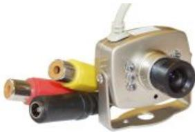
Mit Mikrophon und Halterung. 380 TV-Linien, 537x597 Bildpunkte, S/N Ratio 48 dB, Mindestbeleuchtung 2 Lux, Objektiv 6 mm, Videoausgang 1 V p-p an 75 Ohm mit autom. Gegenlichtkompensation. Arbeitstemperatur: -10°C ..+50°C Stromversorgung. DC: 6 - 12 V / 100 mW Anschluss über Niederspannungsbuchse: 5,5/2,1 mm Maße: 40 x 32 x 33 mm. Pos.N2105 per Stk. nur.. €14,95
