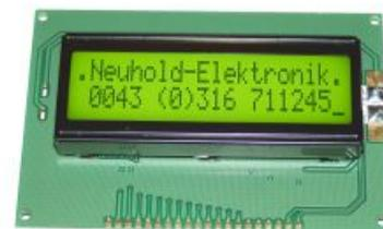
LC-Display mit grüner LED-Hintergrundbeleuchtung, Controller ist HDD 44780 kompatibel. 2x20 Zeichen Einfacher Anschluss über 20-polige Löt-leiste. Betriebsspannung +5 V. Anzeigefläche 73x19,8 mm. Maße (LxBxH): 96x66x16 mm. Pos.N2090 nur... €4,50
