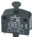
1-poliger 6A/250V~ Öffner, 6,3mm Flachsteckanschlüsse. Zur Befestigung sind im Gehäuse 2 Bohrungen mit 4,3 mm Durchmesser.
