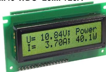
Auf einem beleuchtbaren, zweizeiligen LC-Display werden die Messwerte für Strom, Spannung und Leistung gleichzeitig angezeigt. Die Strommessung erfolgt galvanisch getrennt. Es können Ströme im Bereich -20 bis + 20 A gemessen werden. **Technische Daten:**
