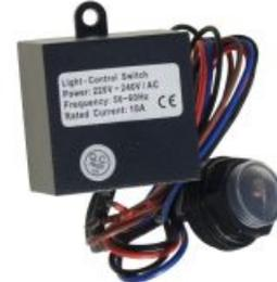
Dient zur bequemen lichtgesteuerten Schaltung von Lampen und Leuchten bis 6A mit externem Lichtsensor( Länge der Zuleitung ca. 400mm), Schaltschwelle < 50 Lux. Betriebsspannung 230V/AC 50-60Hz. Maße LxTxH 44x44x30mm. Maße des Sensors-(Durchm.) 20mm. Befestigung des Sensors erfolgt über Schraubgewinde des Sensors mit Mutter. Pos.N2175 Sensor nur..... €6,90
